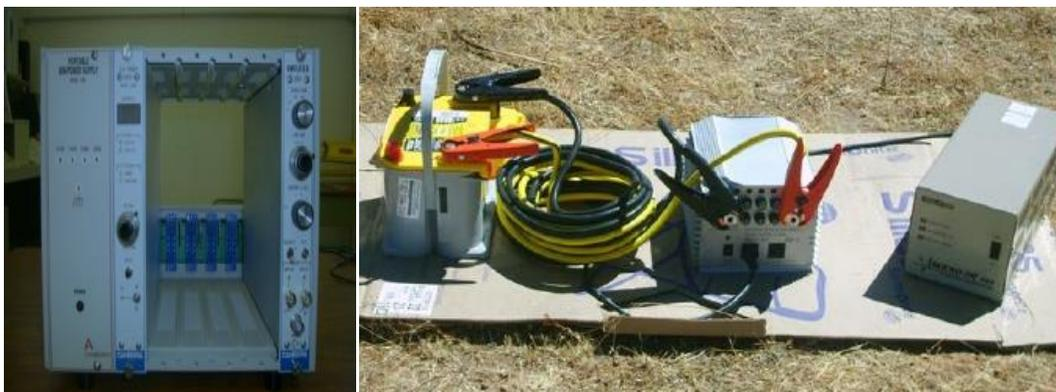
*Figura 9 Gabinete NIM portátil modelo 100. Batería de gel Optima D75/25, inversor de poder electrónico Invercom y soporte electrónico regulado Micro SR 480.*
