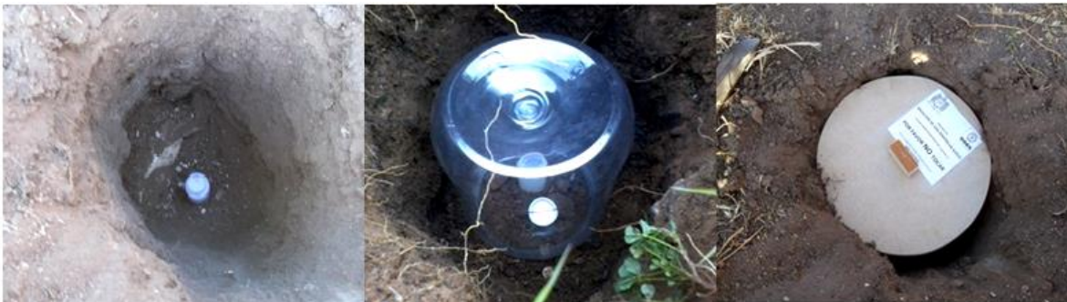
Figura 8. Colocación in situ del vial abierto y cámara de exposición para acumular radón
