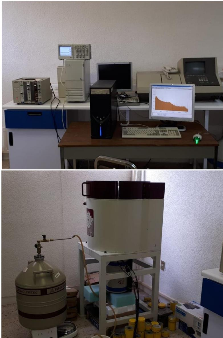
*Figura 13. Arreglo experimental del equipo de espectrometría gamma en el Laboratorio de la UAEN.*
