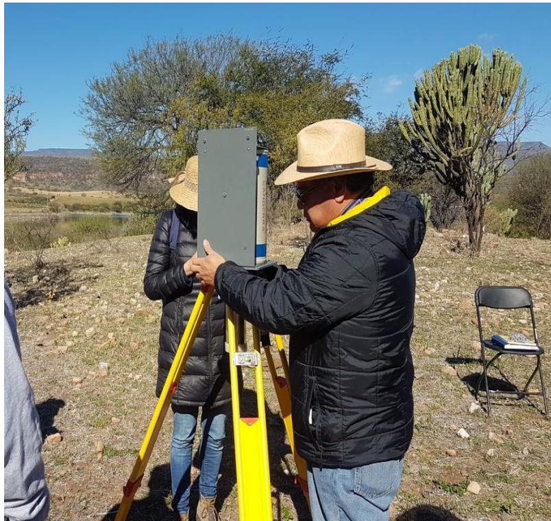
*Figura 11. Acomodo del detector para las mediciones In Situ.*
