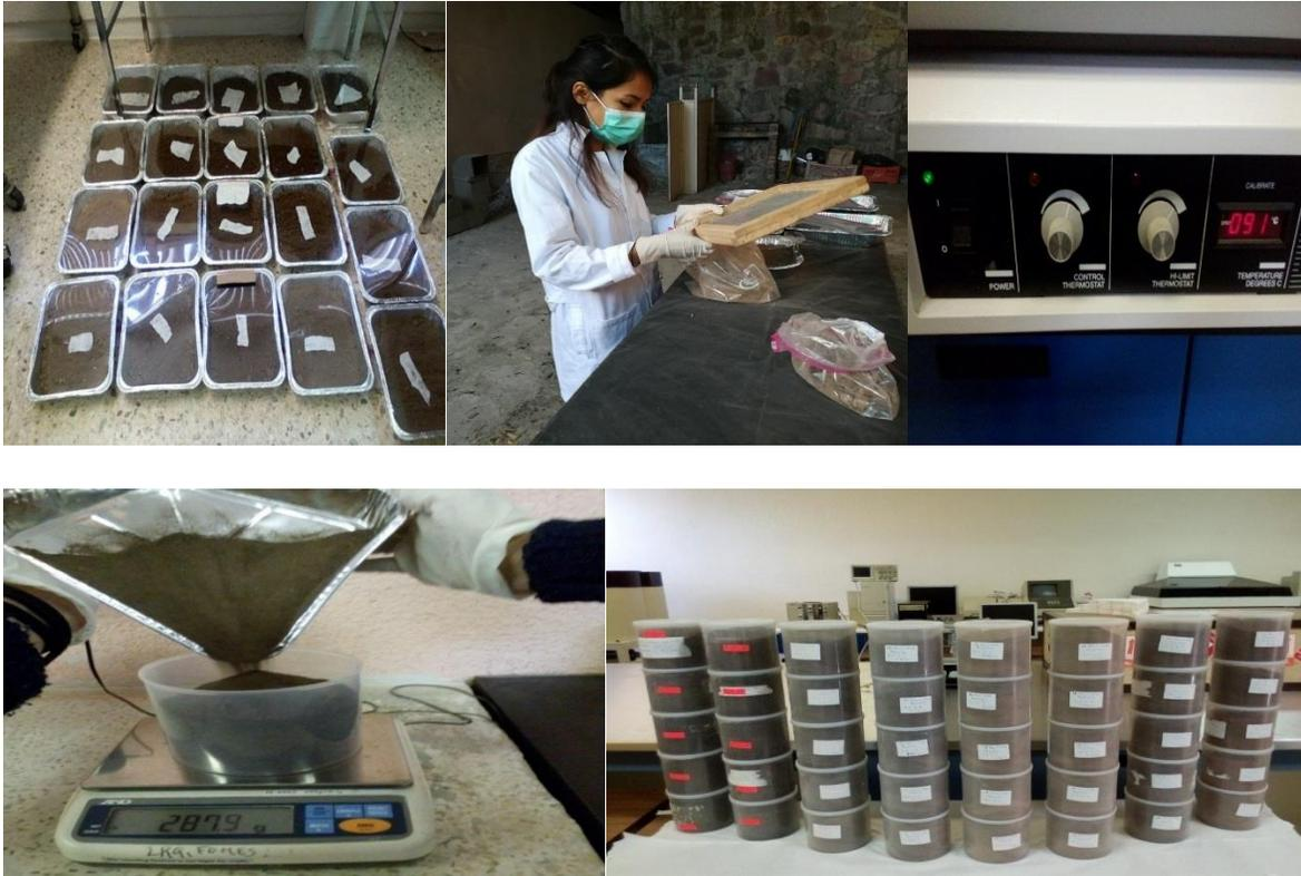
*Figura 15. Tratamiento dado a las muestras previo a la medición (Eliminación del exceso de humedad, tamizado, secado en estufa, envasado y sellado).*
