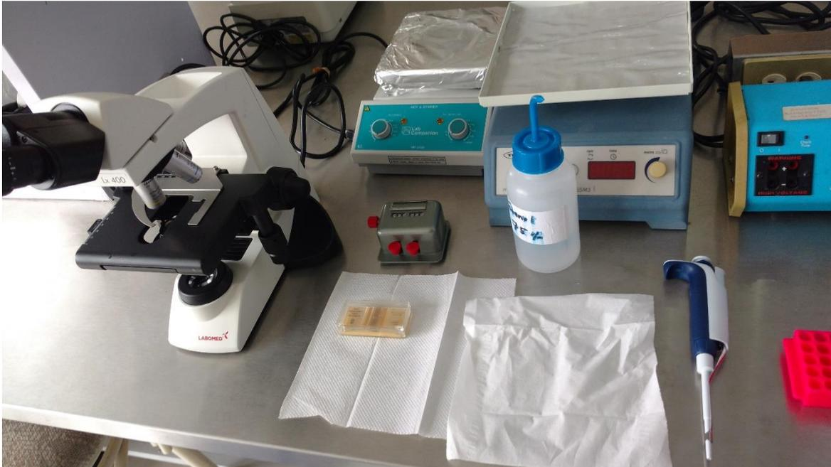
**Fig. 18 Microscopio óptico y cámara de Neubauer.**
