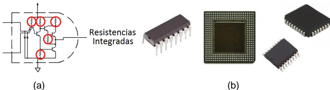
**Figura 2.15. a) Resistencias integradas en un sustrato de silicio, b) Circuitos Integrados.**
