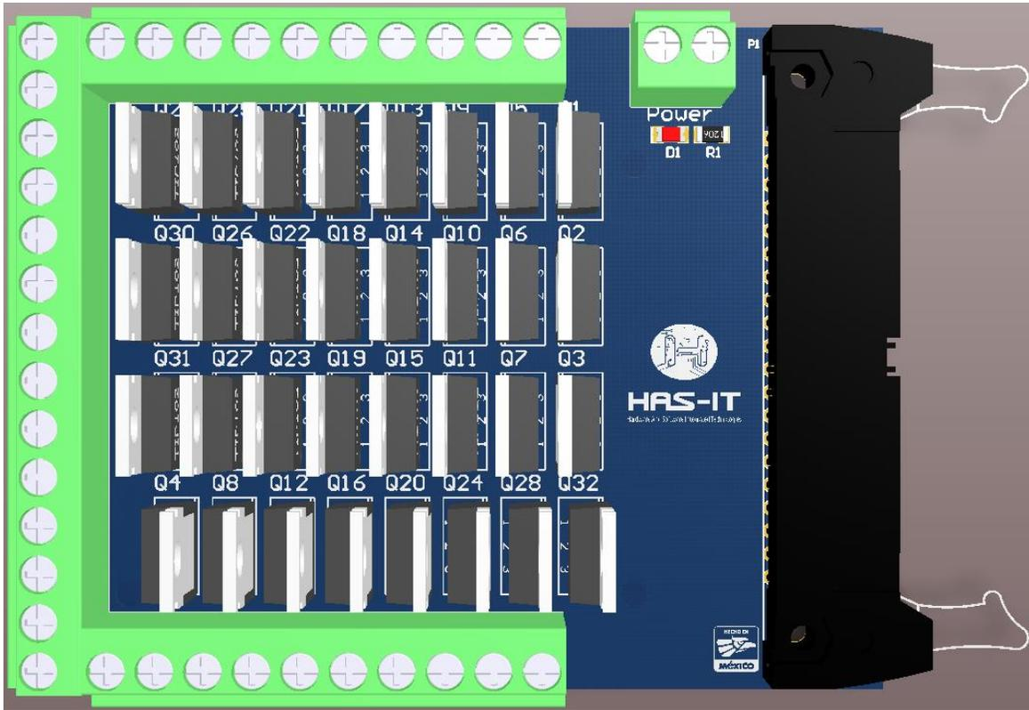
Figura 4.43. Diseño PCB-Potencia - Vista Superior 3D.
