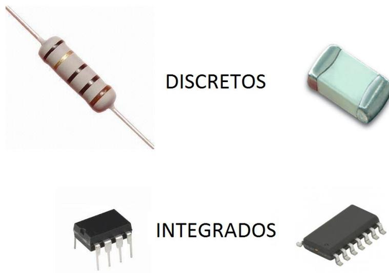
**Figura 2.14. Componentes discretos e Integrados.**
