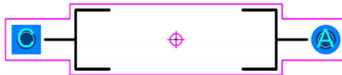
Figura 2.81. Footprint de componente Axial de orificio.
