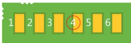
**Figura 3.27. Espaciado de serigrafía sobre componentes.**
