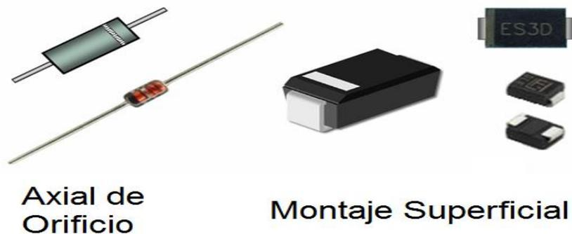
**Figura 2.38. Tipos de empaquetado de Diodos.**
