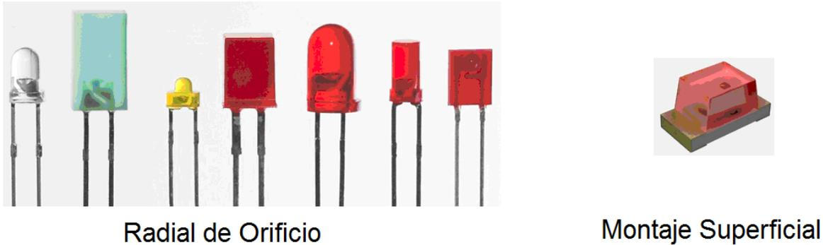
**Figura 2.39. Tipos de empaquetado LED.**
