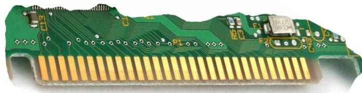
**Figura 2.47. Conector de borde de tarjeta.**
