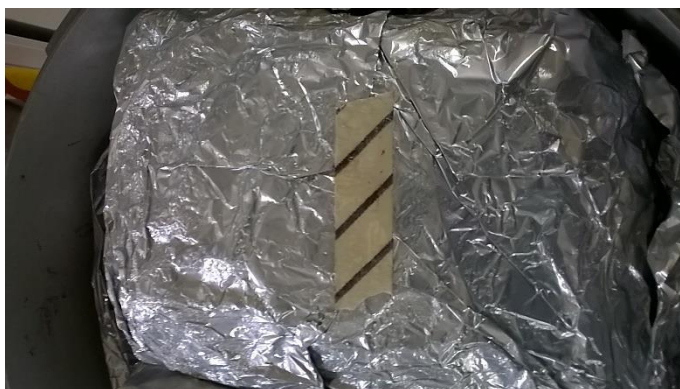
Figura 176: Vista de la cinta testigo que autentifica la esterilización.
