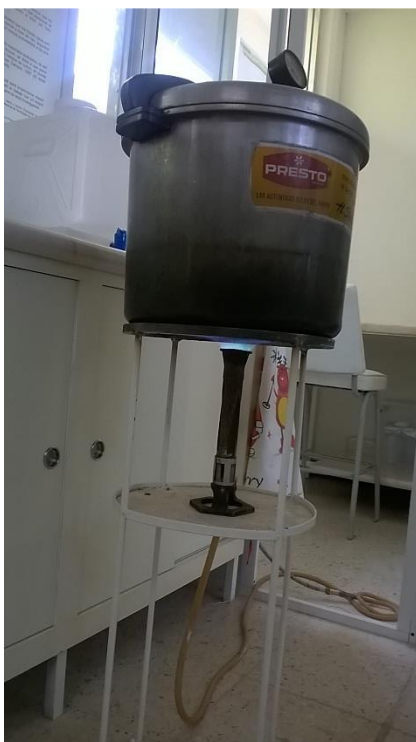
Figura 177: Olla express, tripie y mechero para esterilizar muestras de suelo.
