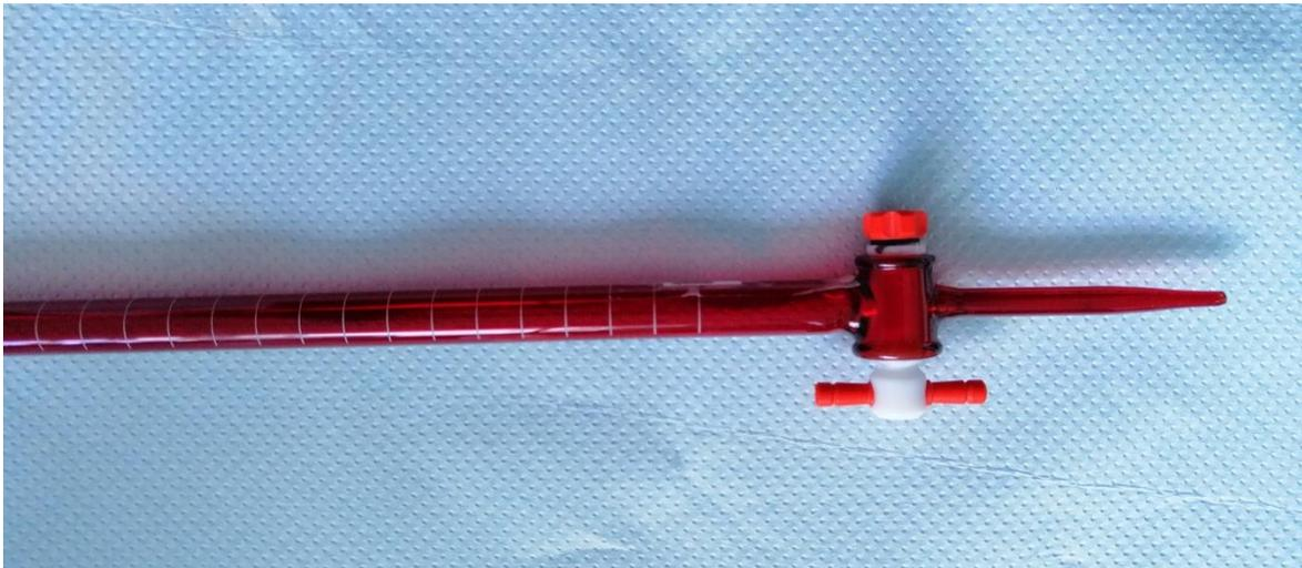
Figura 4: Bureta utilizada para calcular viscosidad dinámica.
