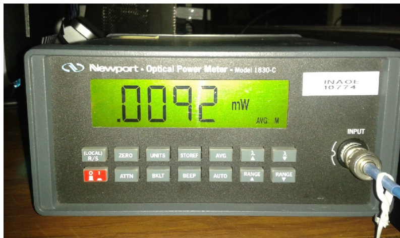
Figura 3.5 Intensidad de las irradiancias mostrada en el medidor óptico de potencia.
