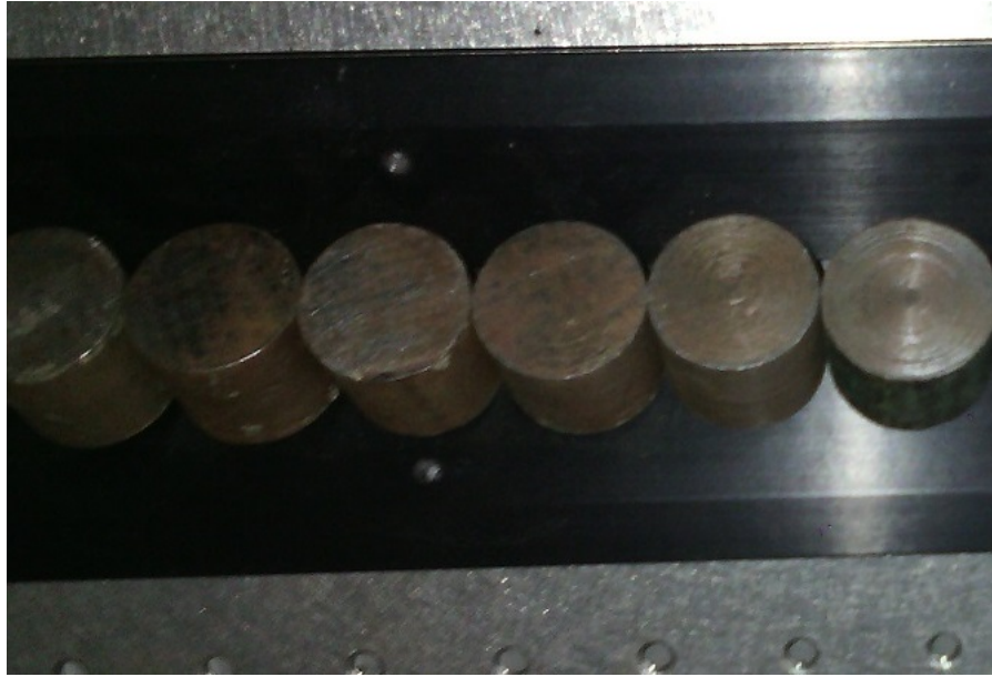
Figura 4.14 Pesos controlados para la prueba ESPI Vertical.
