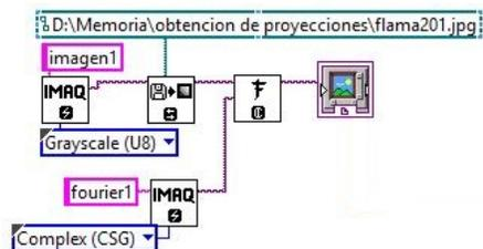
(a) Diagrama a bloques para la transformada de Fourier de la Flama
