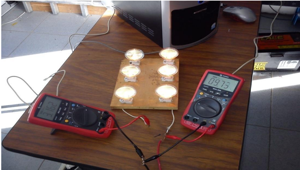
Figura 21. Carga de lámparas de 120Watts conectadas a los multímetros y al panel solar.
