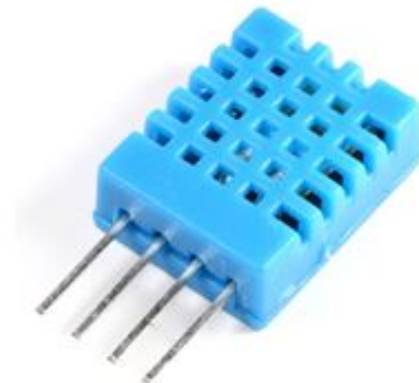
Figura 3.2: Sensor de temperatura y humedad relativa DHT11.
