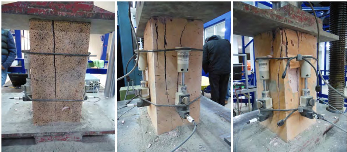
Figura 5.19 Fallas presentadas en el prisma QS-09 de cantera rosada una vez terminada la prueba mecánica a compresión axial.
