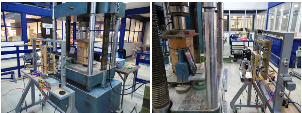
Figura 5.16 Soporte robótico para el ajuste y nivelación de la cámara digital colocado en posición frontal a la máquina universal durante las pruebas mecánicas a compresión.
