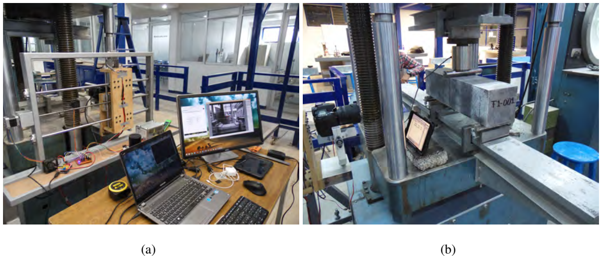
Figura 5.26 Configuración del sistema adquisición de datos para la técnica de correlación digital de imágenes: (a) Utilización del software de control de la cámara digital; (b) Ubicación del dispositivo electrónico portátil para visualización del panel de lecturas de los sensores.
