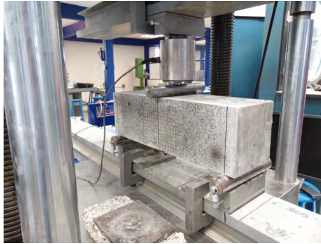
Figura 5.23 Viga de concreto reforzado con fibras de acero montada sobre el dispositivo de ensayos a flexión en tres puntos.
