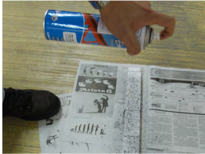
Figura 5.3 Aplicación del patrón de moteado a la superficie de los especímenes de poliestireno expandido.
