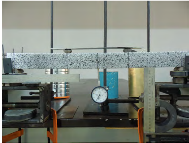
Figura 5.2 Espécimen de poliestireno expandido montado sobre el soporte de ensayos a flexión en cuatro puntos.
