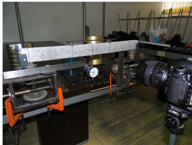
Figura 5.5 Configuración experimental de la técnica de correlación digital de imágenes en dos dimensiones.
