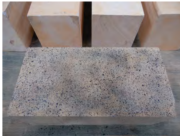
Figura 5.14 Espécimen de cantera rosada preparado con patrón de moteado para la aplicación de la técnica de correlación digital de imágenes.
