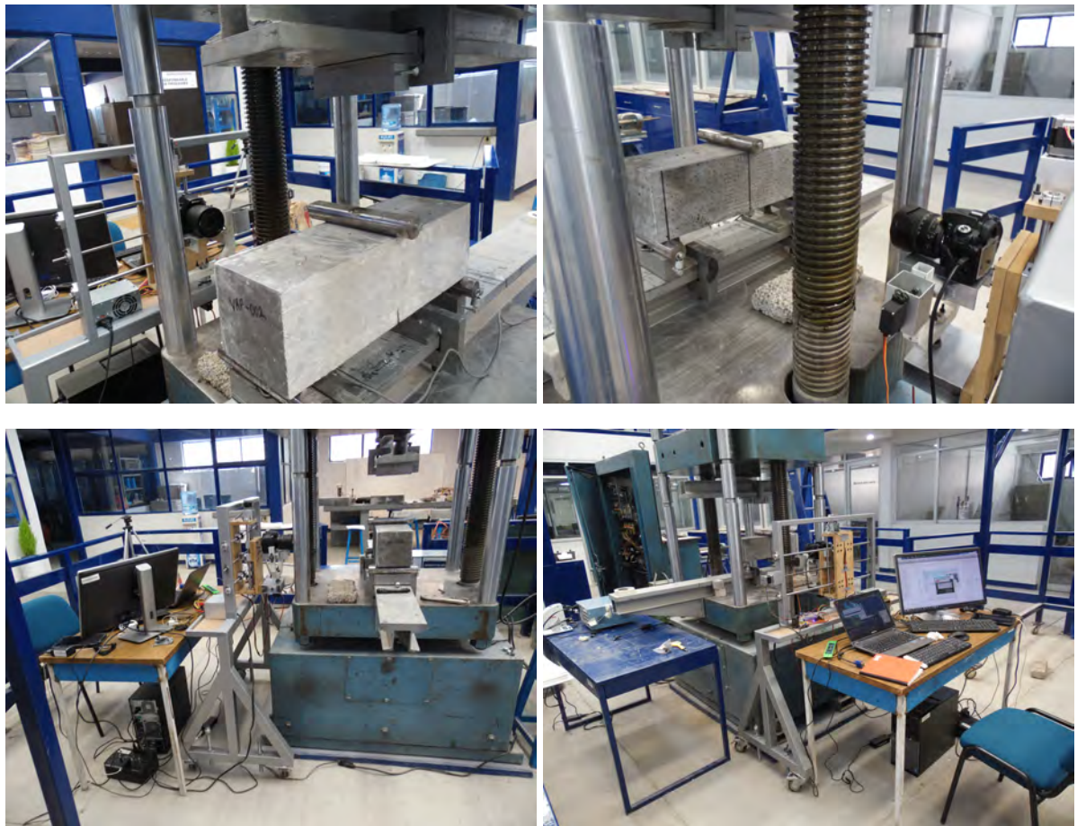
Figura 5.25 Cámara digital montada en el soporte robótico posicionado junto a la máquina universal de ensayos mecánicos.
