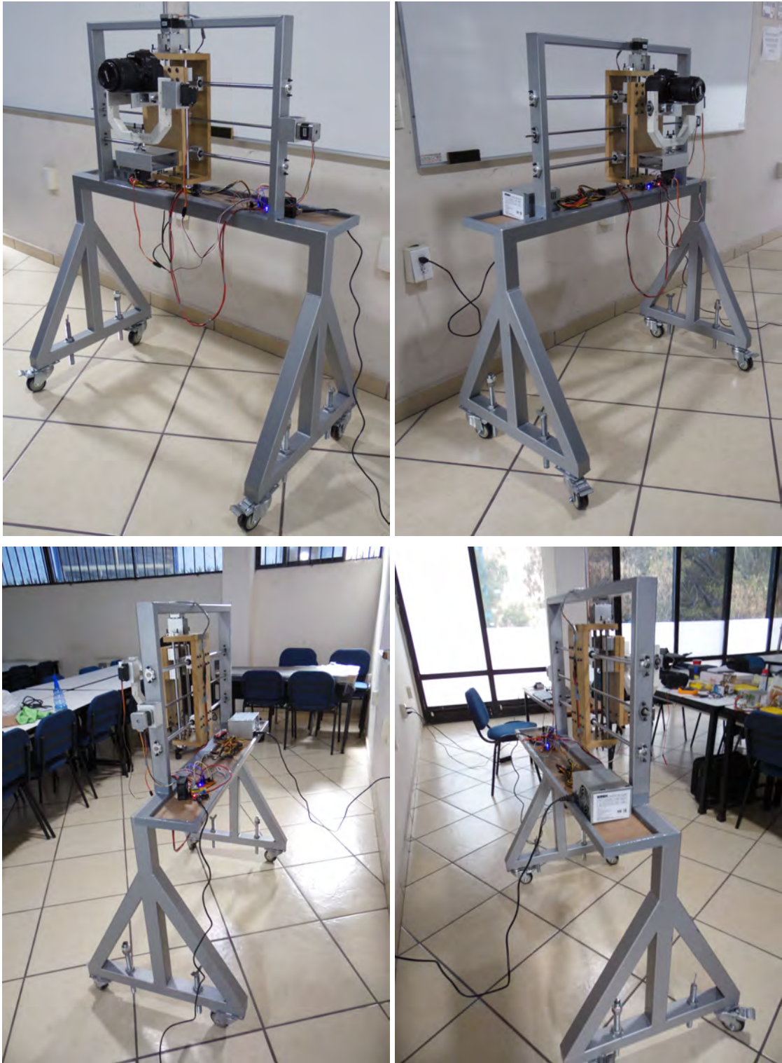
Figura 4.23 Prototipo final de soporte robótico para control de cámaras digitales en aplicaciones con la técnica de correlación digital de imágenes (vista en perspectiva).
