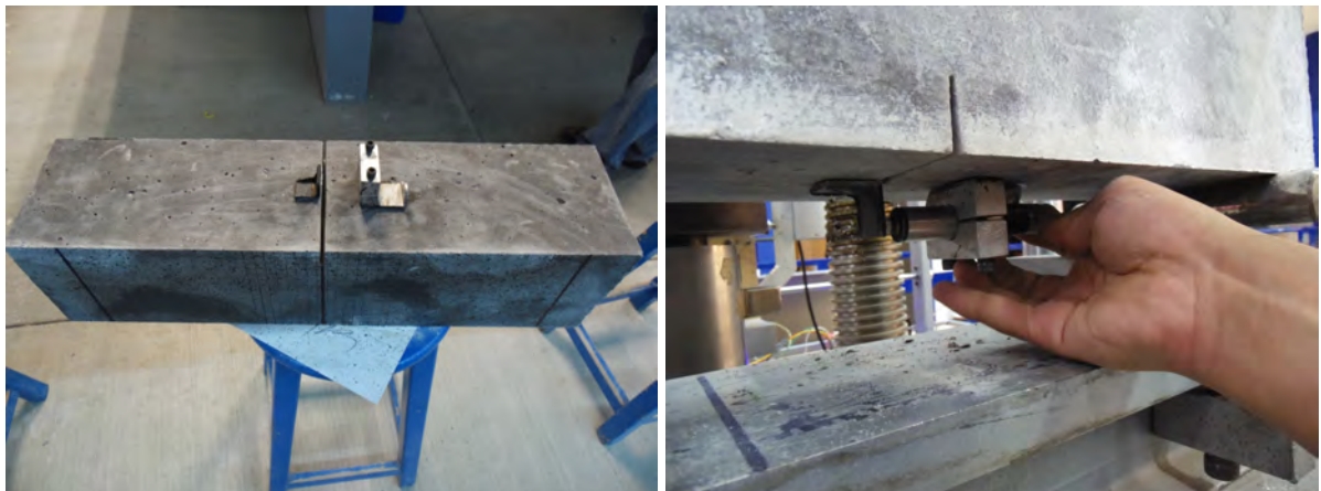
Figura 5.22 Colocación del sensor de desplazamiento lineal sobre la muesca central en el lecho inferior de la viga de concreto reforzado con fibras de acero.
