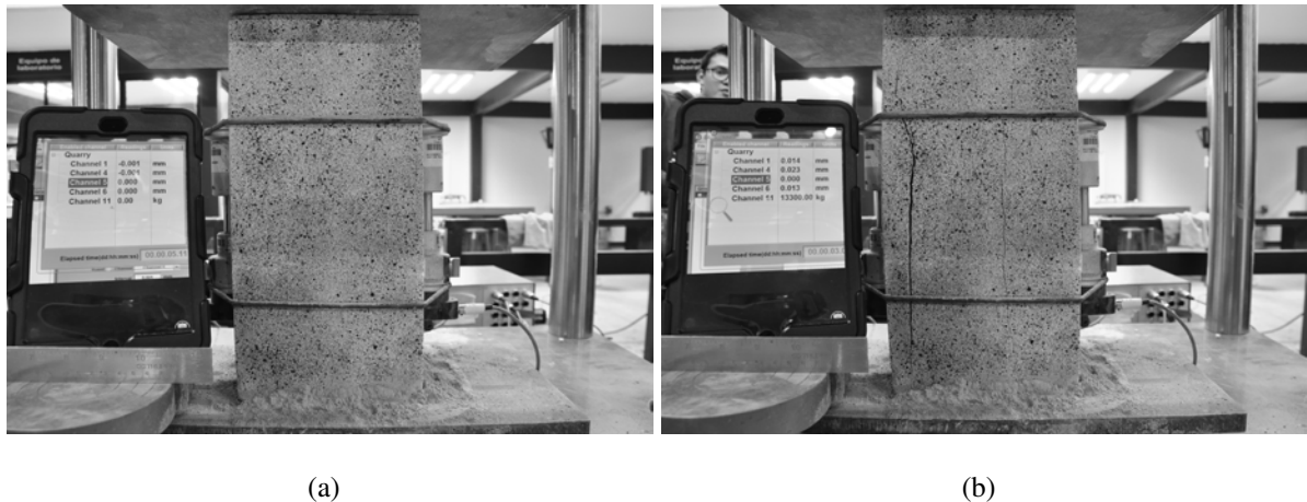
Figura 5.17 Fotografías del prisma de cantera rosada antes y después de la prueba mecánica a compresión axial: (a) Imagen de referencia inicial antes de la aplicación de la carga; (b) Imagen deformada del material una vez alcanzada la carga máxima.
