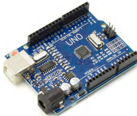
Figura 4.15 Placa Arduino UNO modelo R3.
