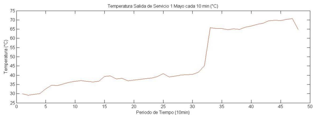
Figura 4.104 Temperatura salida servicio del tanque: 01 de Mayo 2015.
