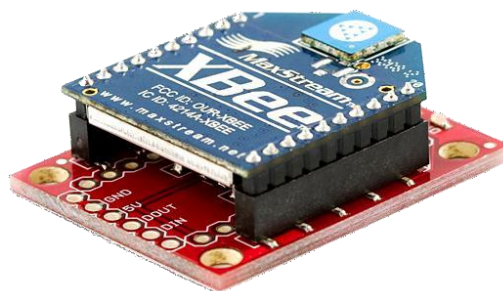
Figura 3.13. Módulo Xbee montado sobre base reguladora de voltaje SparkFun XBee Explorer Regulated .
