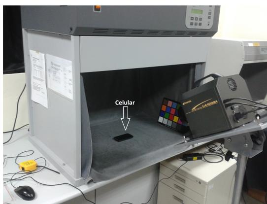
Figura 3.21 Medición de colores de la pantalla a cada celular.
