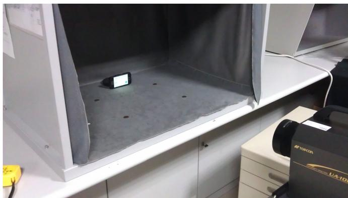
Figura 3.24 Medición 45/0 de las pantallas de los celulares.
