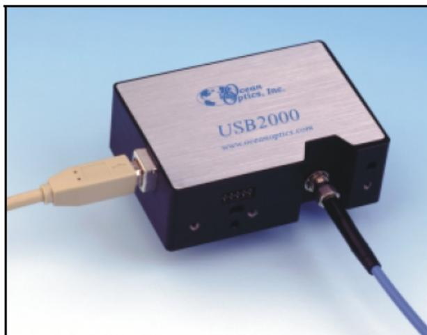
Figura 3.3 Espectrofotómetro Ocean Optics USB 2000.
