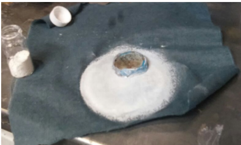
Figura 2.4 Imagen que muestra el contraelectrodo encapsulado en el procedimiento de lijado de acabado espejo en alúmina.
