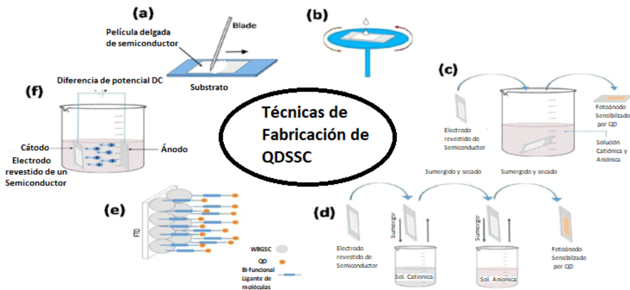
Figura 1.4 Ilustración de (a) "doctor blade", (b) recubrimiento por rotación, (c) CBD, (d) SILAR, (e) unión del entretejido molecular y (f) técnicas electroforéticas para la fabricación de QDSSC. [55]
