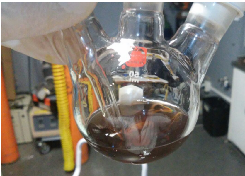
Figura 5.1 Preparación puntos cuánticos de CdSe en un matraz de 3 bocas hechos por el método de inyección caliente.
