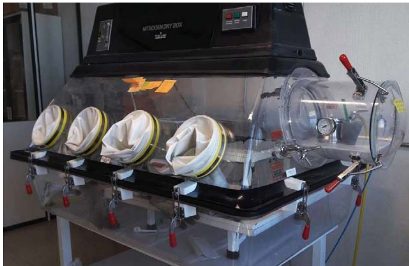
Figura 3-5 Cámara de guantes
