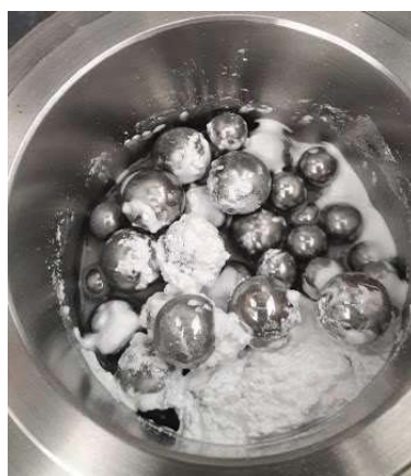
Figura 3-3 Limpieza de viales y bolas
