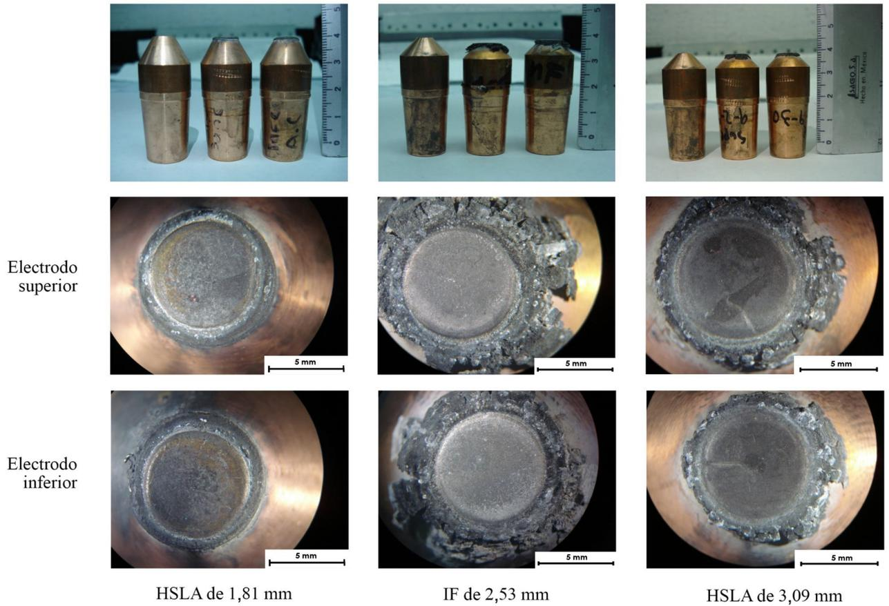
**Figura 7** Desgaste de la cara de contacto de los electrodos después de 1.000 puntos de soldadura.
