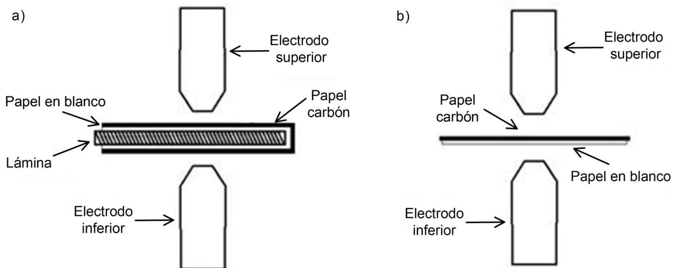
**Figura 1** Esquema de impresión de la cara de los electrodos: (a) Impresión de electrodo superior e inferior y (b) Impresión de la combinación de ambos electrodos [12].
