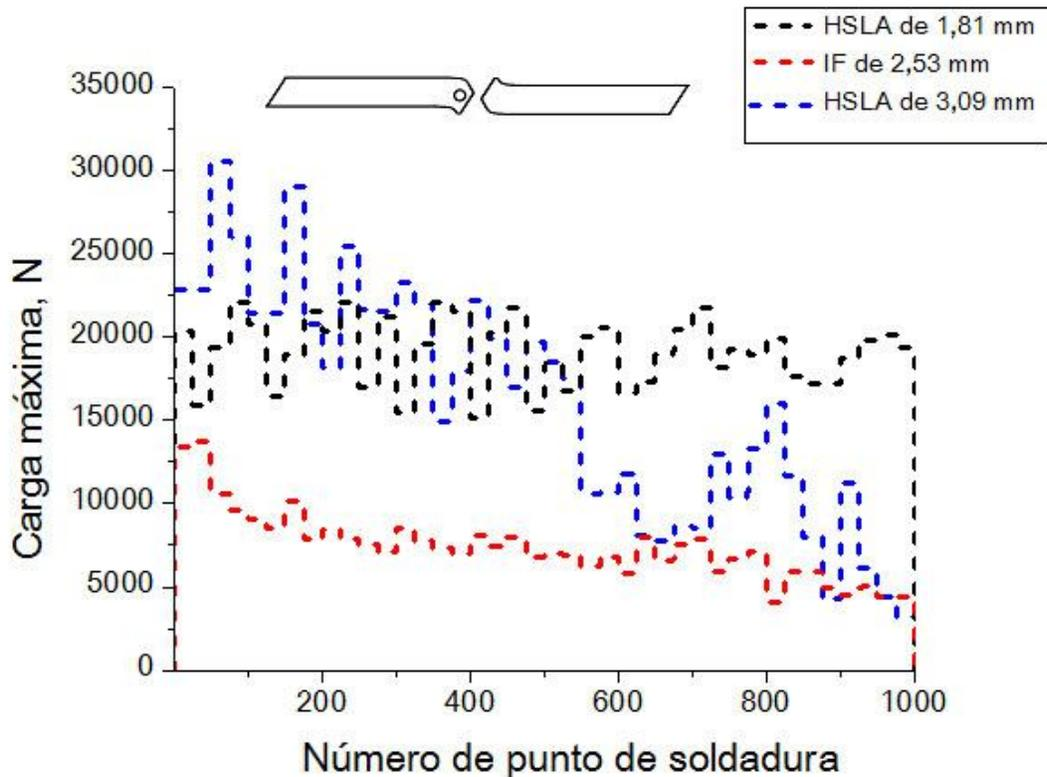
**Figura 16** Carga máxima de los ensayos de tensión.
