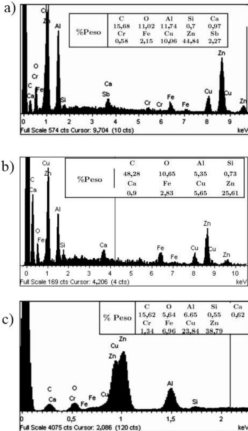
**Figura 9** Espectroscopia de rayos-X sobre la superficie del electrodo utilizado sobre los aceros; (a) HSLA de 1,81 mm, (b) IF de 2,53 mm y (c) HSLA de 3,09 mm.
