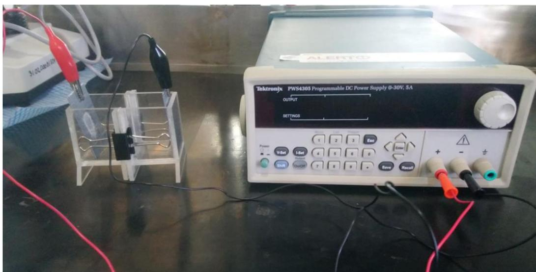
**Figura 3.3** Fuente de poder y celda utilizada para la electrodeposición masiva.
