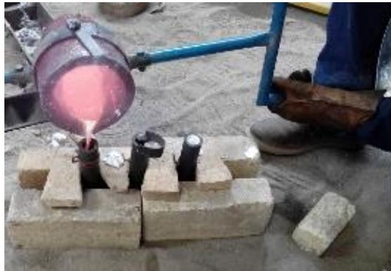
**Figura 14 Vaciado en Molde metálico para pruebas de tensión.**
