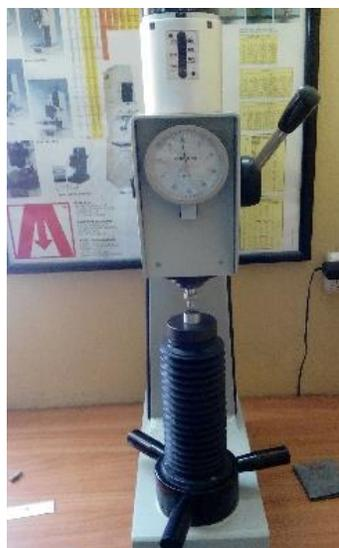
**Figura 20 Durómetro**
