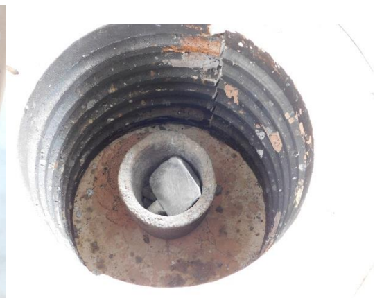
Figura 4.15 Crisol con aleación en horno eléctrico de inducción por 30 min a 700 °C
