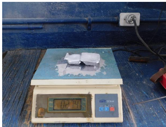
Figura 4.11 Pesado de aleación de Al-5Fe
