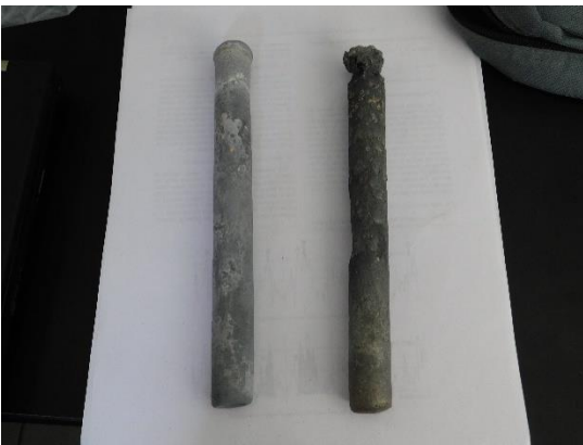
Figura 4.22 Muestras obtenidas de cada aleación de forma cilíndrica de 200 mm de largo por 20 mm de diámetro.
