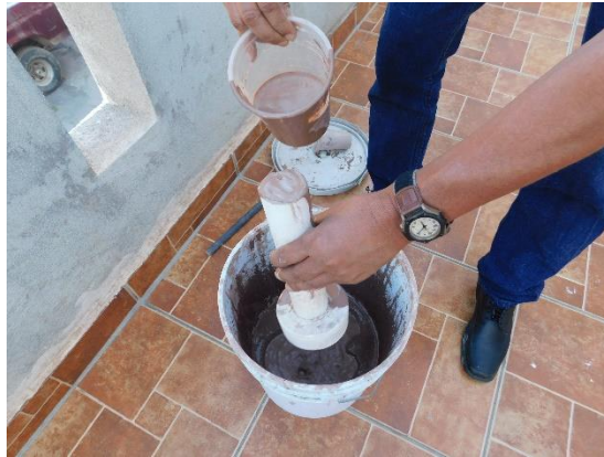
Figura 4.3 Paso 2 Se vierte la arcilla barbotina en el molde de yeso
