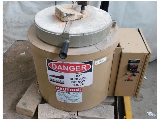
Figura 4.13 Horno eléctrico de inducción donde se llevó a cabo la fundición a 700 °C y se mantiene a 600 °C el metal líquido por 4 hrs
