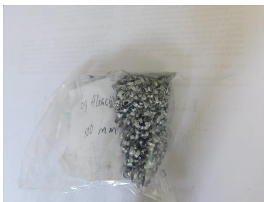
Figura 4.26 Imagen de rebaba recolectada en torno para análisis de composición química.
