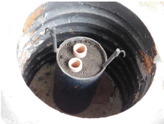
Figura 4.8 Paso 7 Se precalienta el molde a 600 °C por 30 min
