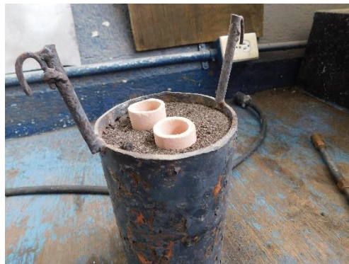
Figura 4.19 Tubos de arcilla barbotina recubiertos por arena para fundición
