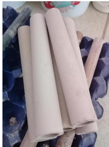
Figura 4.6 Paso 5 se deja secar al sol por 48 horas
