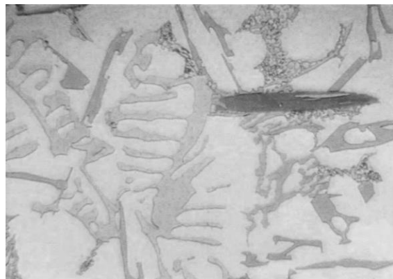
Figura 2.10 Imagen obtenida con electrones secundarios de intermetálico de Al_5Mg_8Si_6Cu_2 formándose como ramificaciones de partículas del Al_2Cu al final de la reacción [8].
