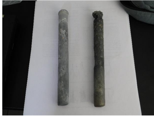
Figura 4.18 Al final se obtienen cinco muestras cilíndricas de 200 mm de largo por 20 mm de diámetro.
