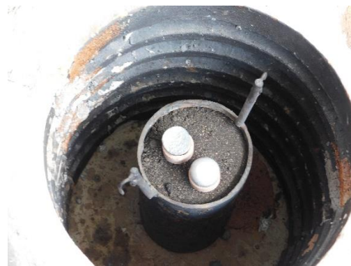
Figura 4.17 La aleación recibe el tratamiento isotérmico a 600 °C permanece por 4 horas, para que precipite y sedimenten los intermetálicos hierro.
