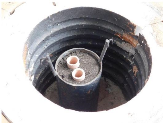
Figura 4.16 Precalentado de moldes a 600 °C.
