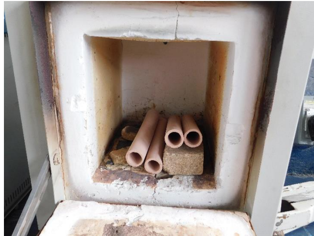
Figura 4.7 Paso 6 se sinterizan a 1100 °C por 30 min
