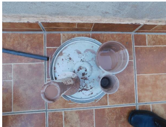
Figura 4.4 Paso 3 se vierte la arcilla barbotina sobrante en el contenedor
