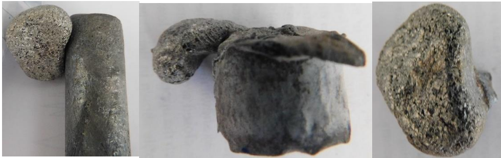
Figura 4.20 Imagen de material tipo flujo de lava fuera del molde.
