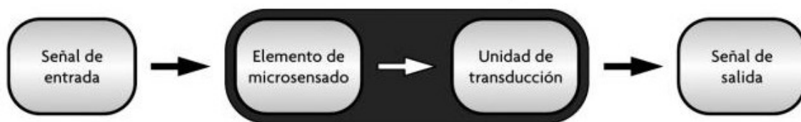
Figura 2. 1 Funcionamiento Básico de un Sensor
