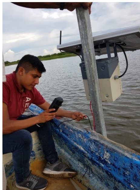
Figura 4. 2 Comparación de los datos de oxígeno disuelto entre el oxímetro y el nodo de monitoreo.
