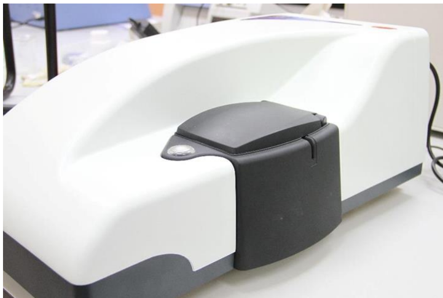
Figura 15.- Imagen del equipo utilizado para las mediciones de DLS y Potencial zeta.
