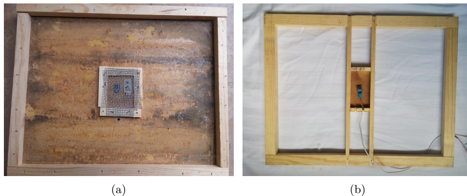
Figura 3.3: Instalación de los micrófonos en el interior de las tapas de las colmenas (a) para el primer experimento y en el marco de madera (b) para el segundo experimento.
