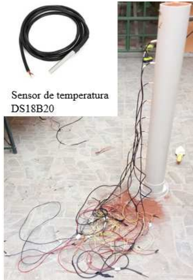
Figura 3-5 Instalación de los sensores de temperatura en el ALI.
