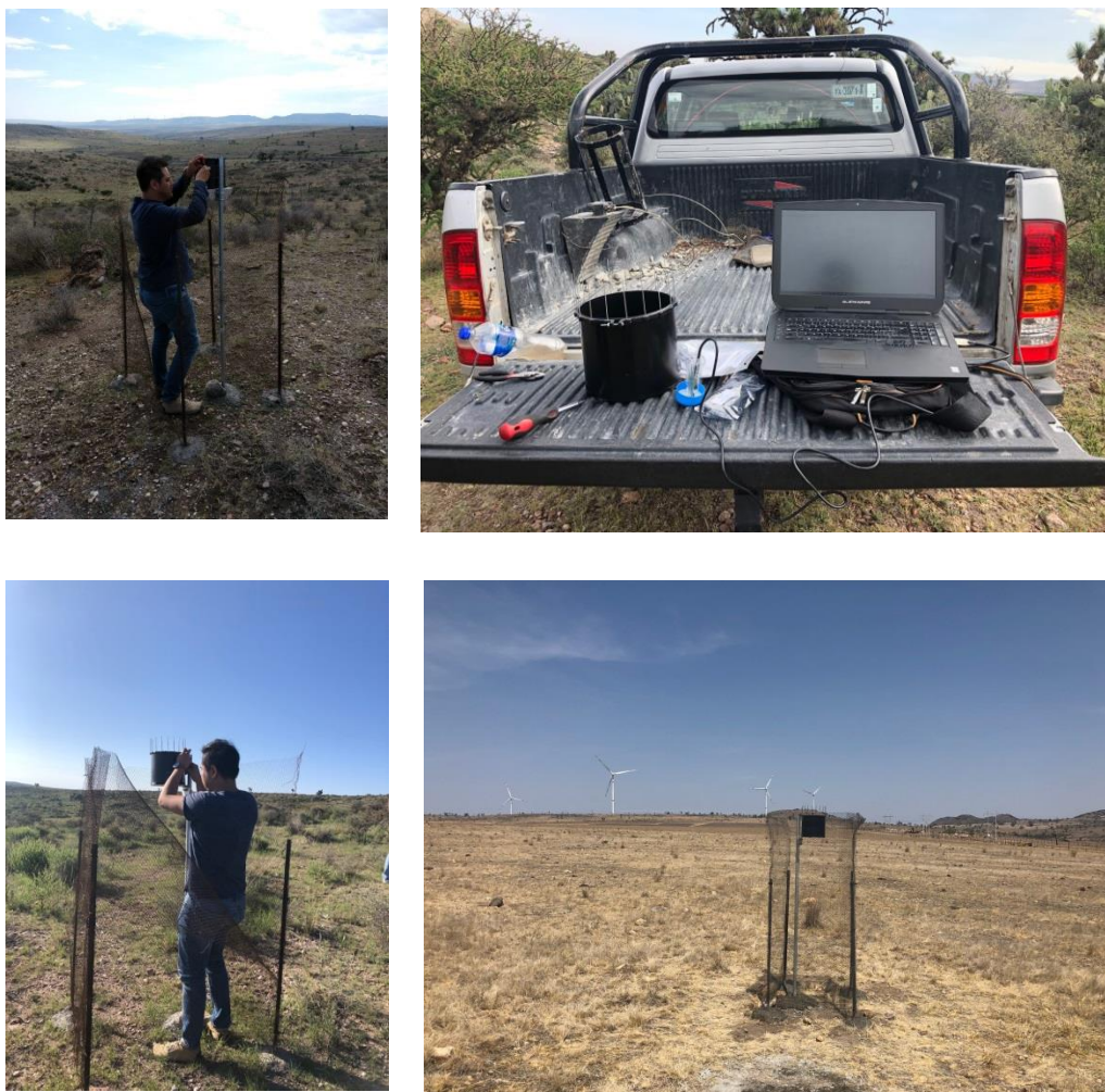
Figura 13. Instalación de las estaciones pluviométricas y estación meteorológica en la cuenca hidrográfica Chilitas.
