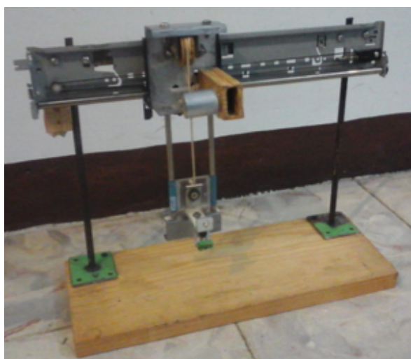
Figura 3. Riel con elevador adaptado a las necesidades específicas de la técnica de depósito.
