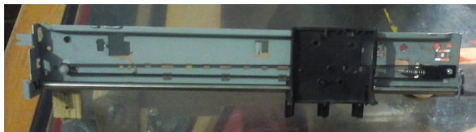
Figura 1. Riel principal de una impresora convencional.
