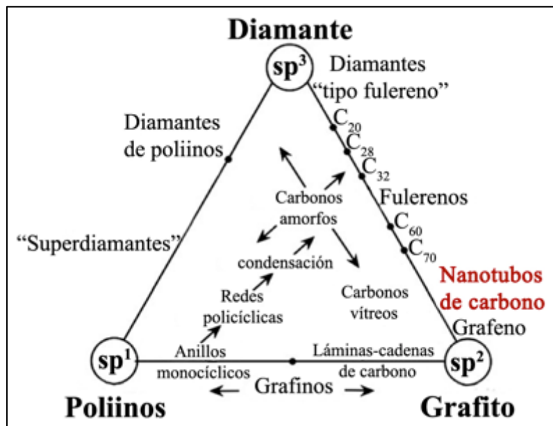
Fig. 2.03. Diagrama de fase ternaria usando las hibridaciones sp^3 , sp^2 , sp^1 del carbono como base para la clasificación de las alotropías conocidas, así como sus formas intermedias del carbono (Korkin, Krstic y Wells. 2010).
