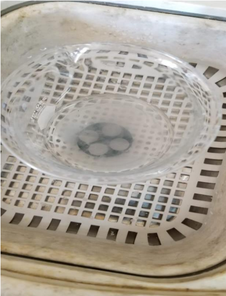
Figura 25. Limpieza de probetas por ultrasonido.
