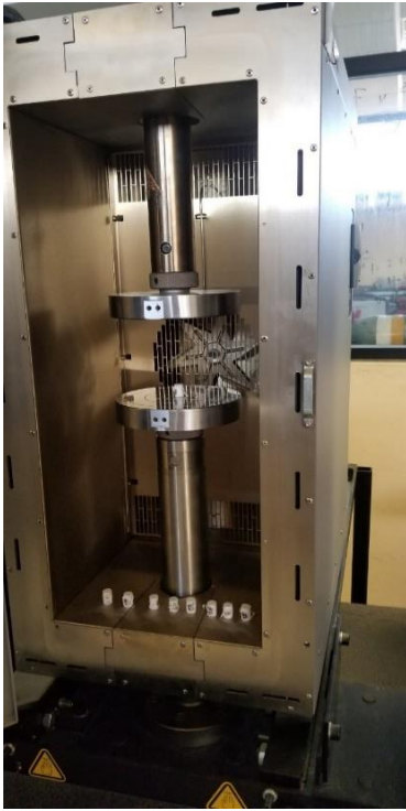
Figura 37. Probetas preparadas en el horno para alcanzar la temperatura deseada y ser sometidas a compresión a alta temperatura.
