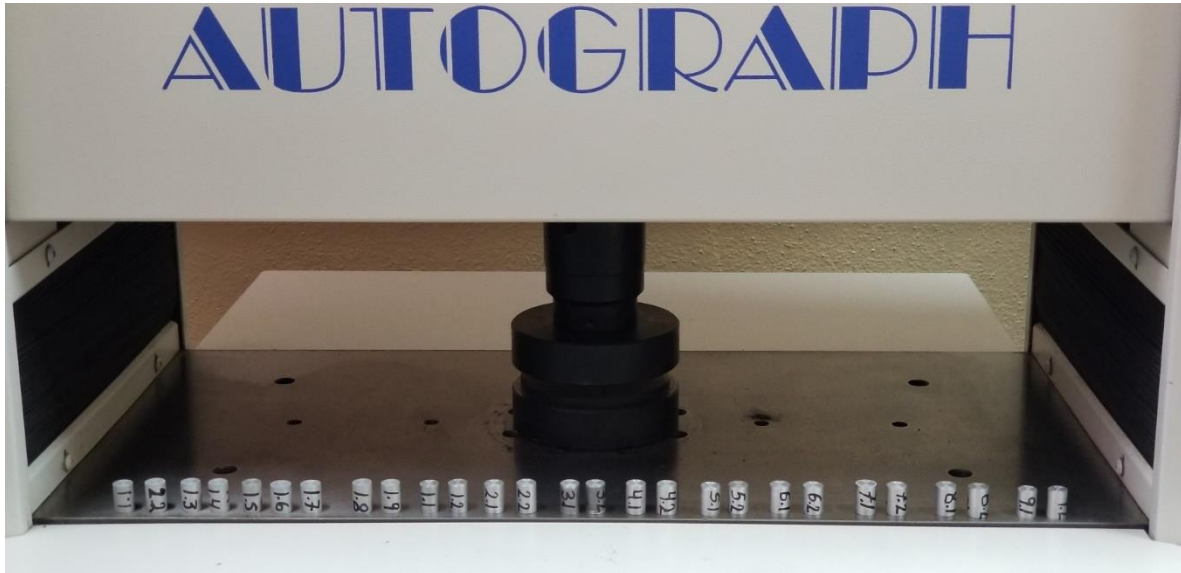
Figura 36. Probetas clasificadas para ser sometidas a pruebas de compresión a temperatura ambiente.
