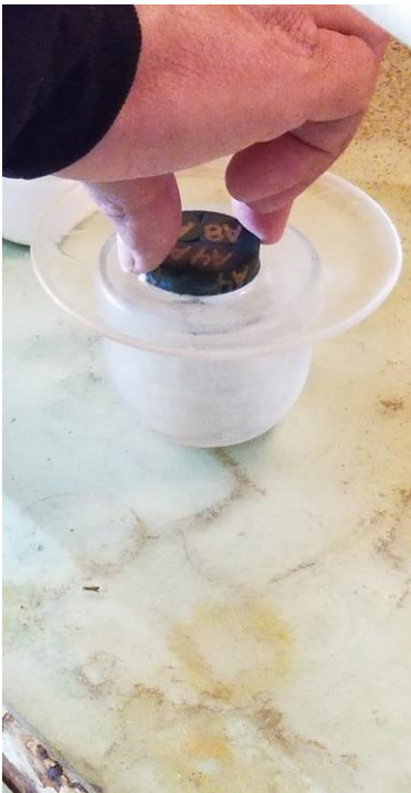
Figura 29. Ataque químico de capsula con cuatro probetas para ser analizados por microscopía electronica de barrido.
