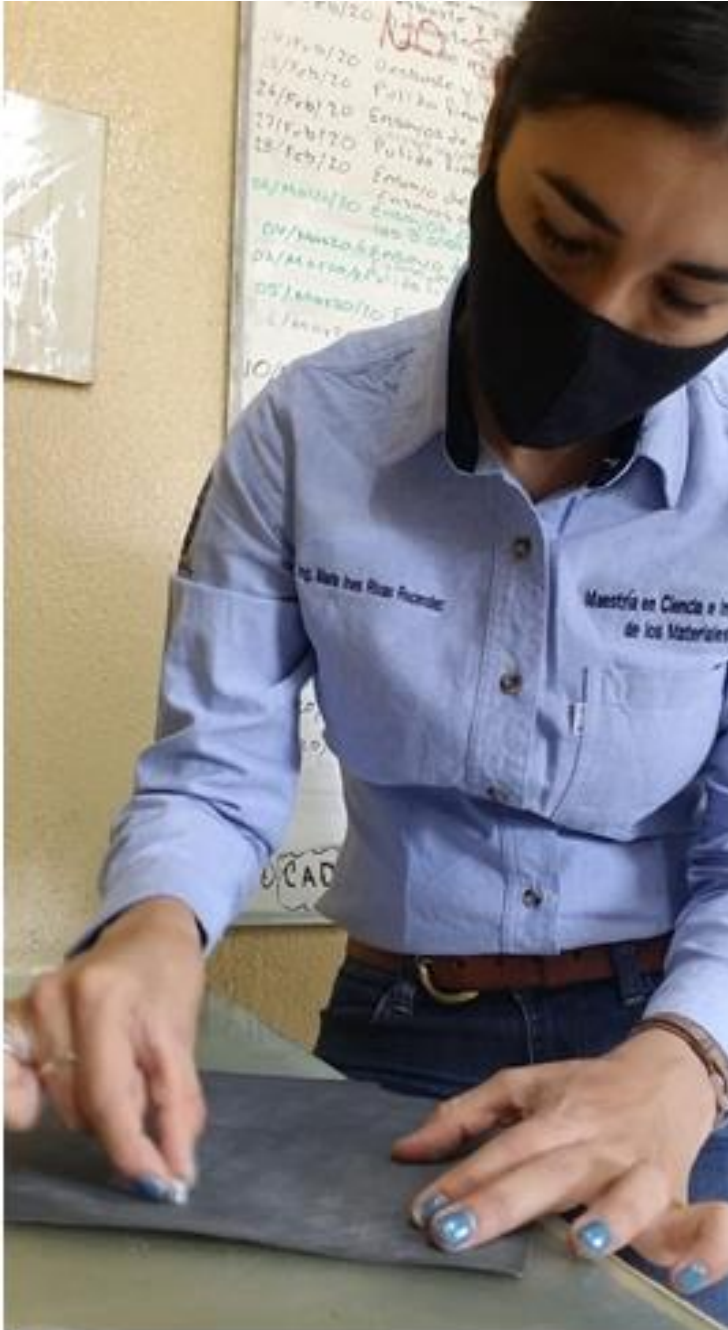
Figura 19. Desbaste de probetas para ser analizadas en microscopía óptica.
