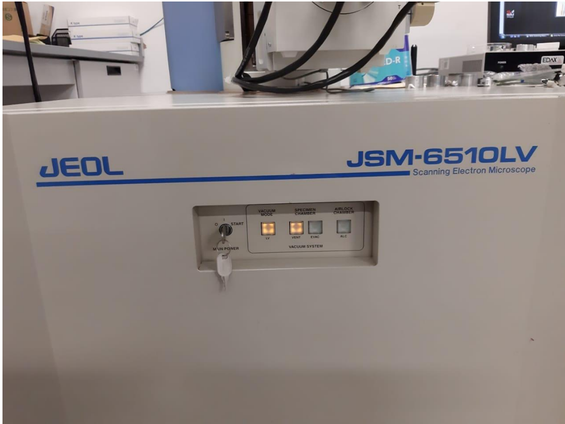
Figura 31. Equipo de microscopía electrónica de barrido con el cual se realizó el análisis a nuestras aleaciones. JEOL, modelo JSM-6510LV.
