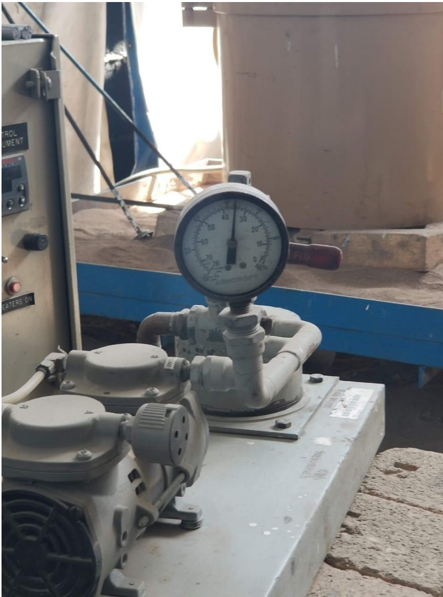
Figura 12. Equipo con el cual se realizó la prueba de presión reducida.
