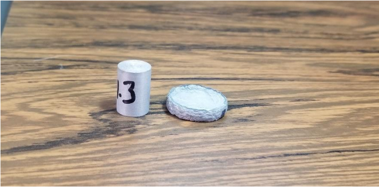
Figura 90. Comparación de probeta antes y después de ser sometida a compresión.
