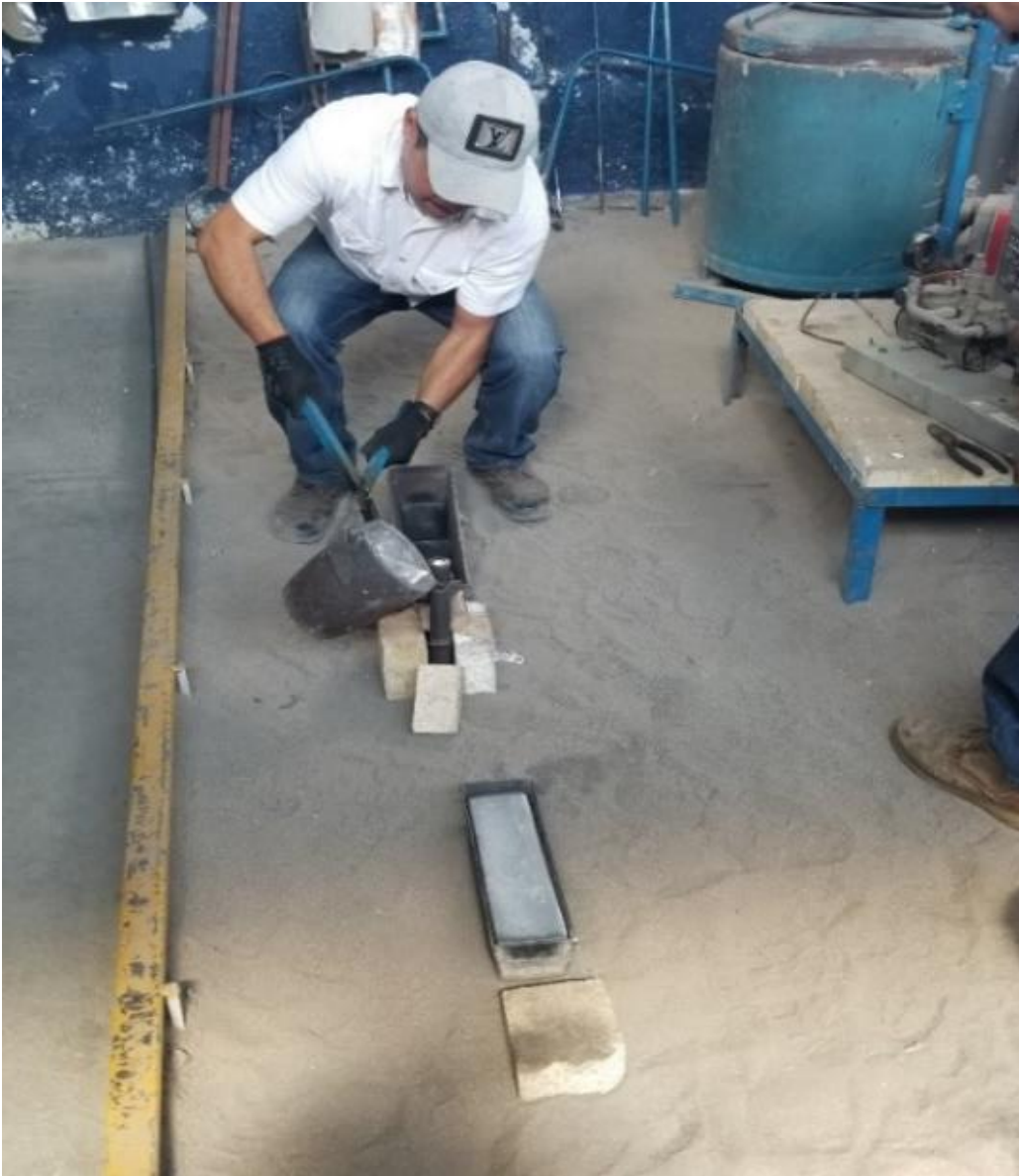
Figura 10. Colado de la aleación base en moldes de metal.
