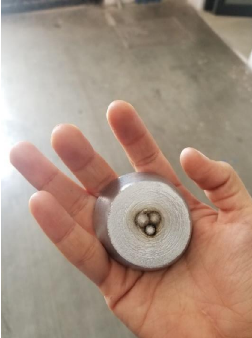
Figura 18. Muestra después de ser sometida a la Espectrometría de emisión por chispa.
