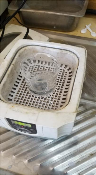
Figura 28. Limpieza de ultrasonido de capsula con cuatro probetas para ser analizadas por microscopía electronica de barrido.
