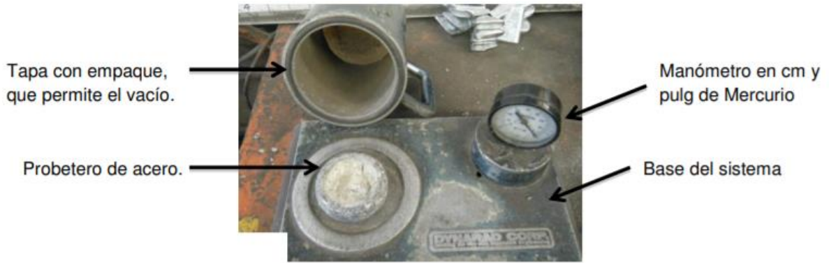
Figura 8. Componentes de equipo utilizado en una prueba de presión reducida.
