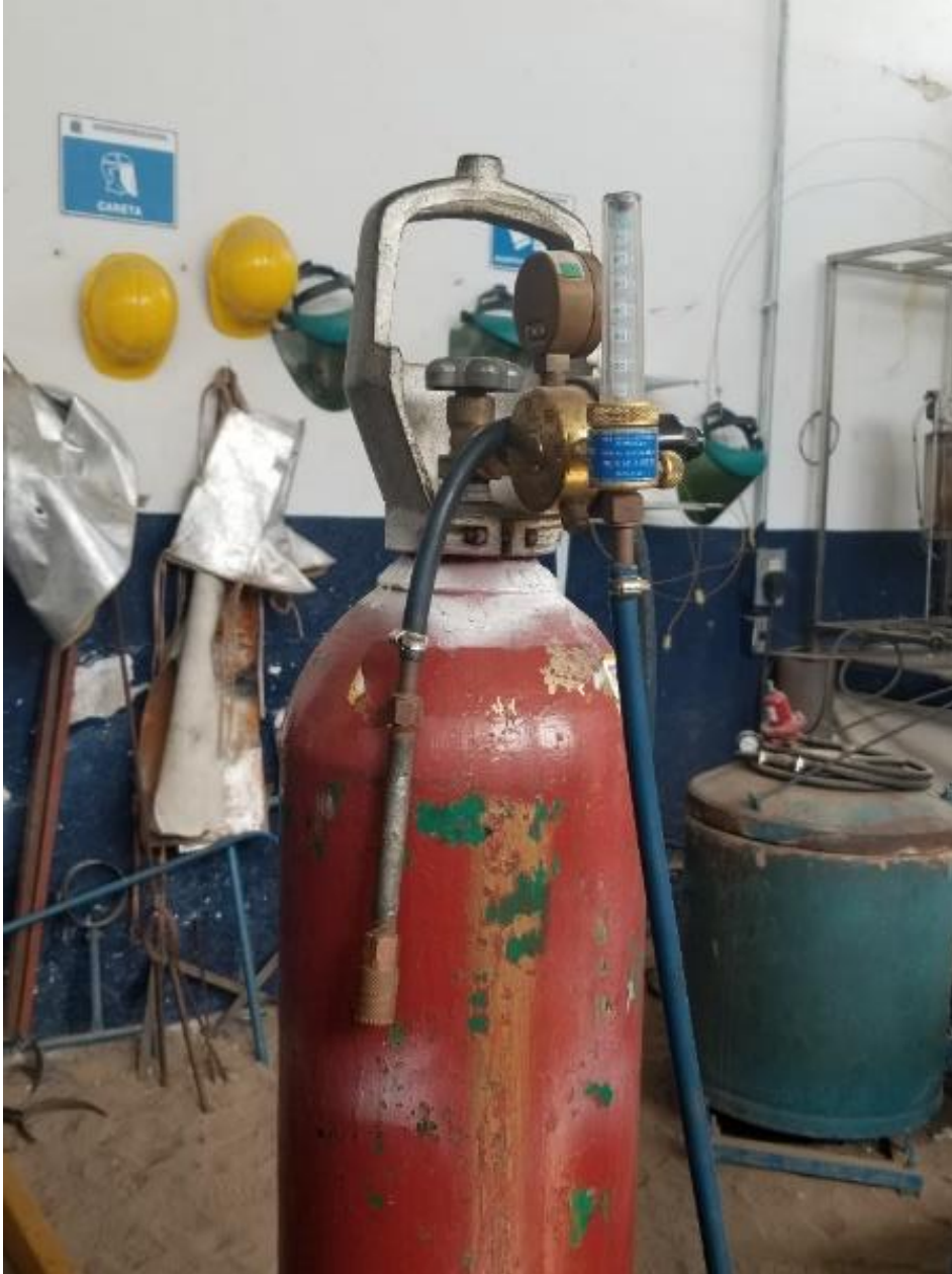
Figura 9. Gas argón utilizado para desgasificar la aleación y evitar poros.
