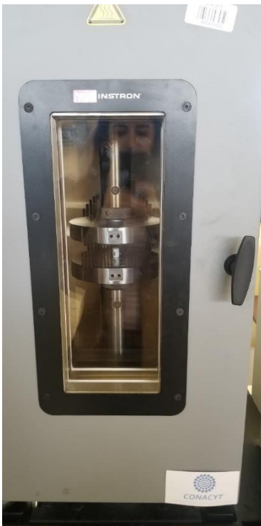
Figura 38. Probeta en prensa a alta temperatura.
