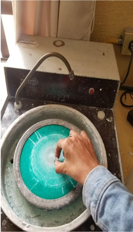
Figura 20. Pulido de probetas en herramienta mecánica.
