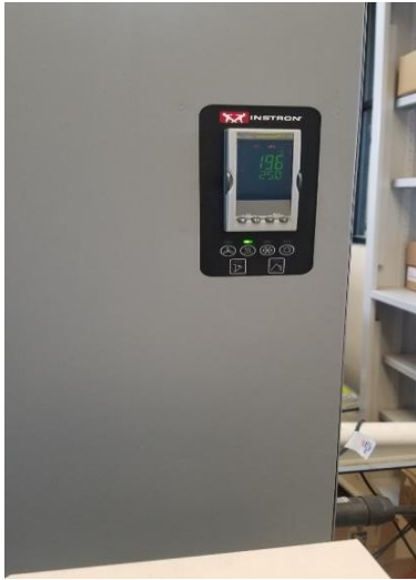
Figura 39. Termostato para verificar la temperatura deseada en la prueba de compresión a alta temperatura.
