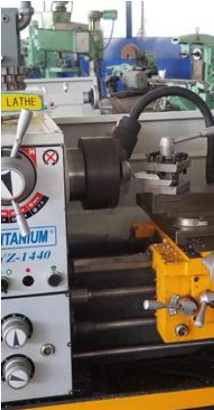
Figura 13. Torno con el que se elaboraron las probetas
