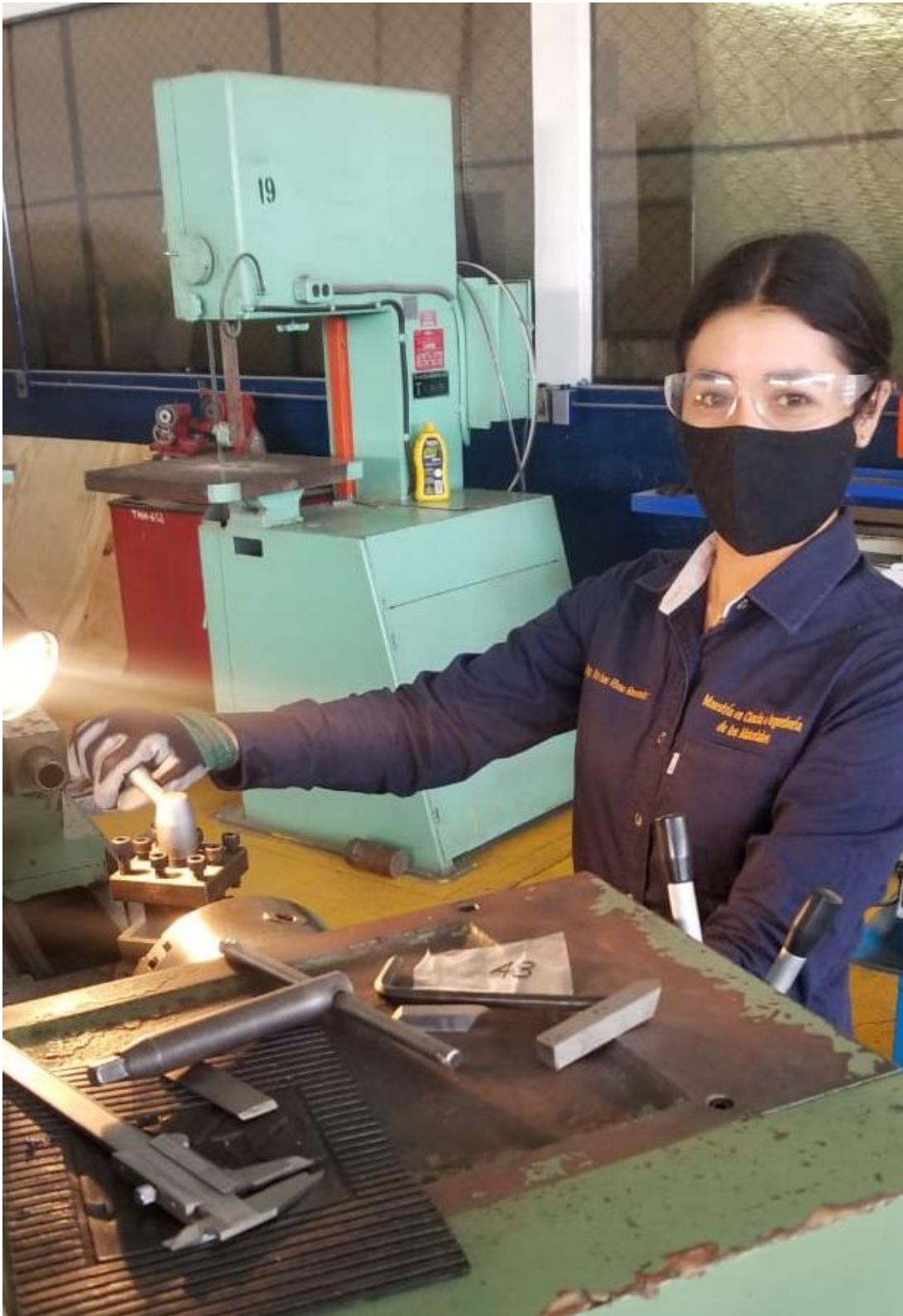
Figura 15. Realizando rectificación de probetas para pruebas específicas
