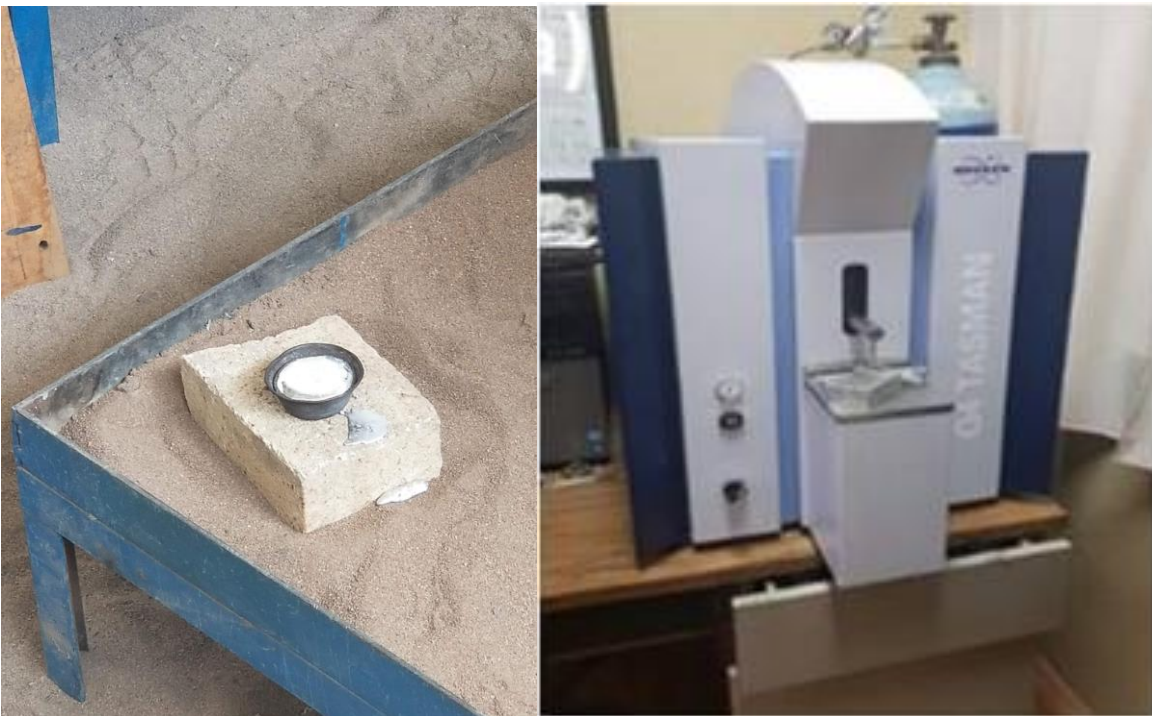
Figura 17. Elaboración de muestra para análisis químico, Espectrómetro de emisión óptica por chispa.
