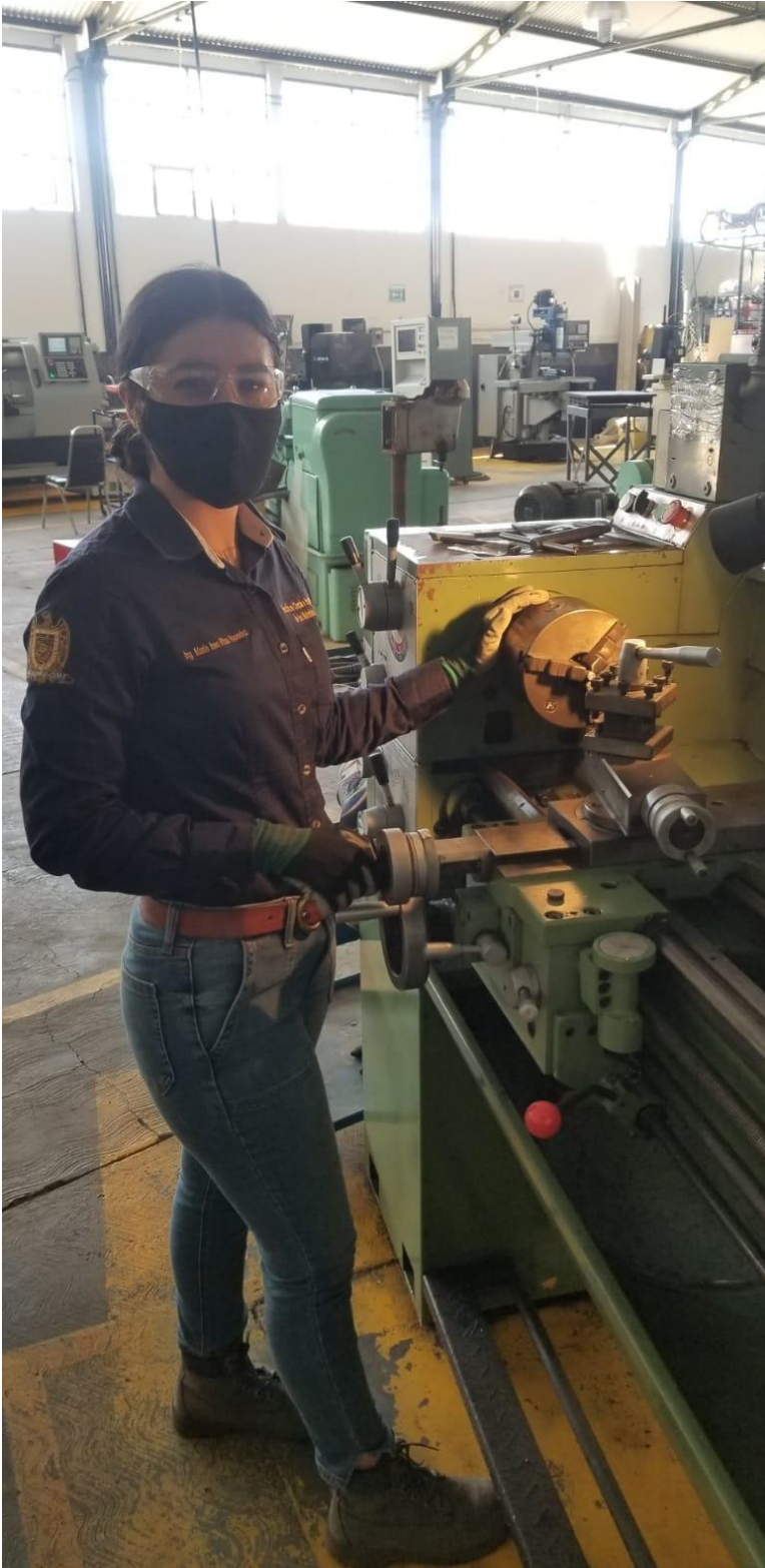
Figura 14. Cortando probetas en torno horizontal.
