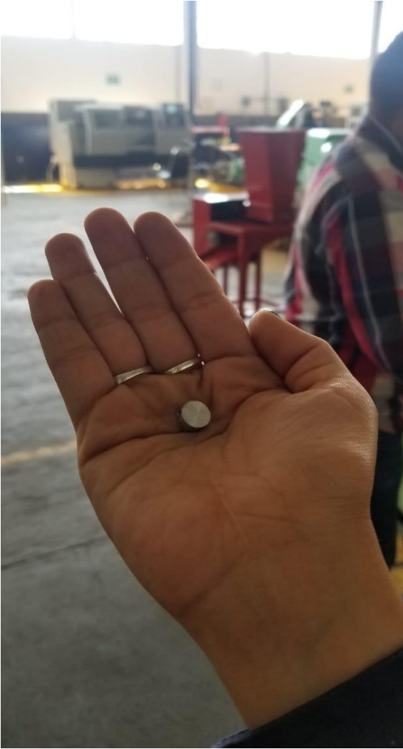
Figura 23. Corte de probetas de 10mm de diametro por < 0.6\text{mm} de altura.
