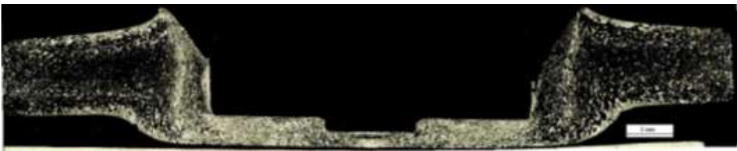
Figura 4-3 Macrografía en sentido transversal a 70 % de penetración.
