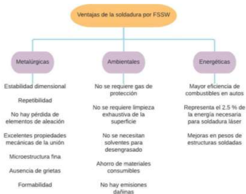
Figura 2-15 Ventajas de la soldadura FSSW [30].
