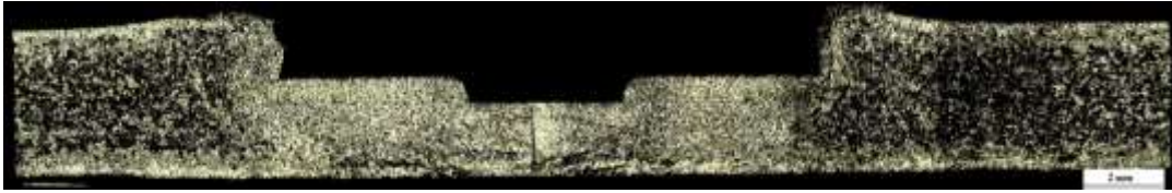
Figura 4-7 Macrografía en sentido longitudinal a 50 % de penetración.
