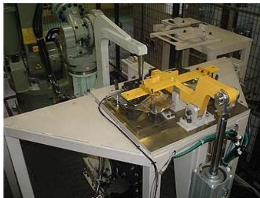
Figura 2-9 Tecnología de Mazda para soldadura FSSW [22].
