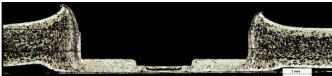
Figura 4-11 Macrografía en sentido longitudinal a 90 % de penetración.
