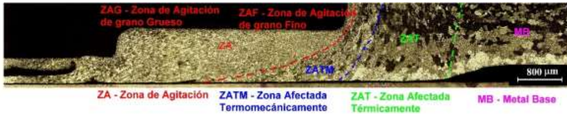
Figura 4-13 Zonas de soldadura.
