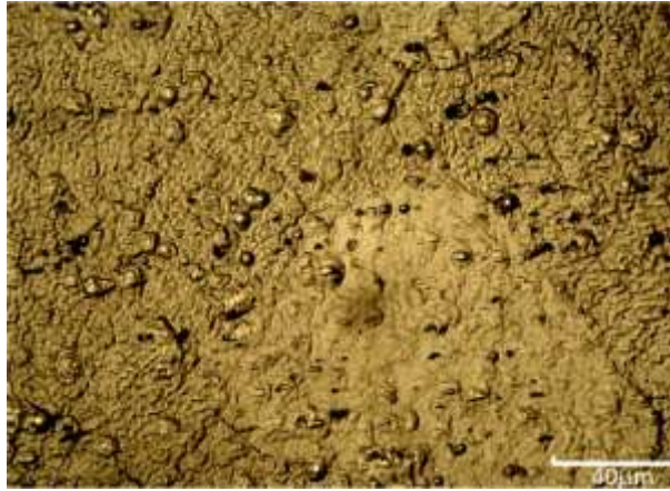
Figura 3-7 Micrografía del AA6063-T6 a 500 x.
