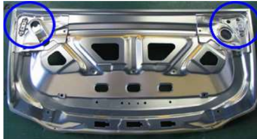
Figura 2-8 Puntos de soldadura en Mazda RX-8 [22].
