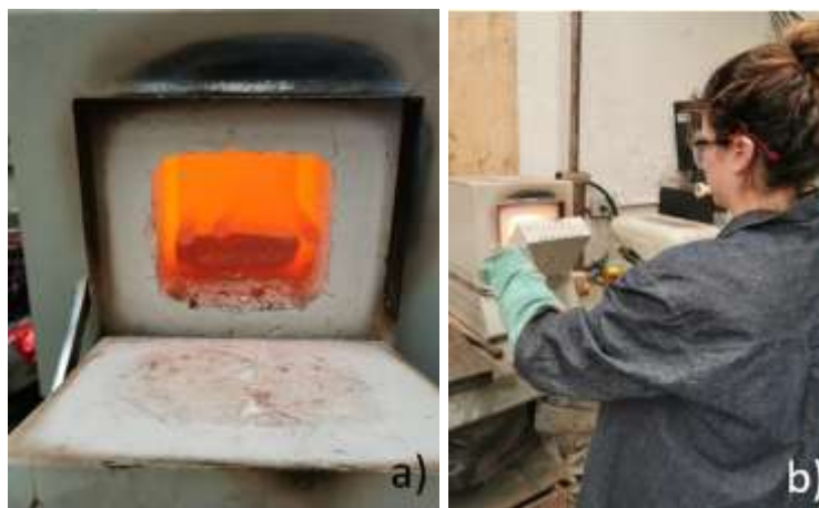
Figura 3-23 a) Herramientas durante tratamiento térmico, b) extracción de herramientas de la mufla.
