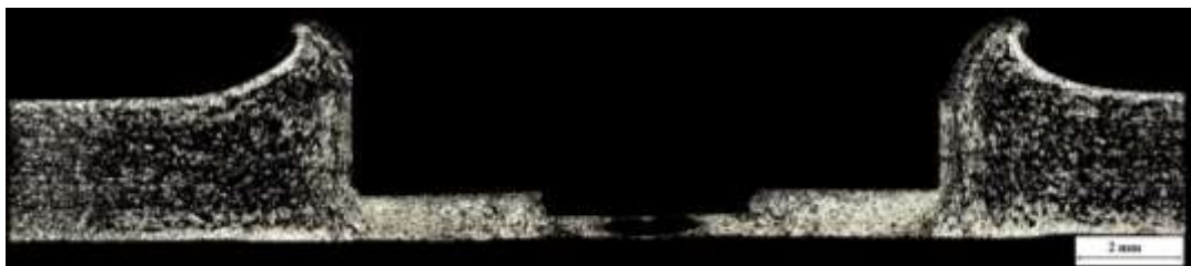
Figura 4-10 Macrografía en sentido longitudinal a 80 % de penetración.
