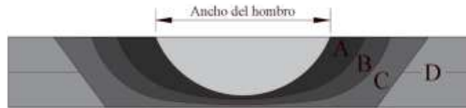
Figura 2-12 Zonas formadas por FSSW: a) zona de agitación, b) zona afectada termo-mecánicamente, c) zona afectada por el calor, d) metal base [27].
