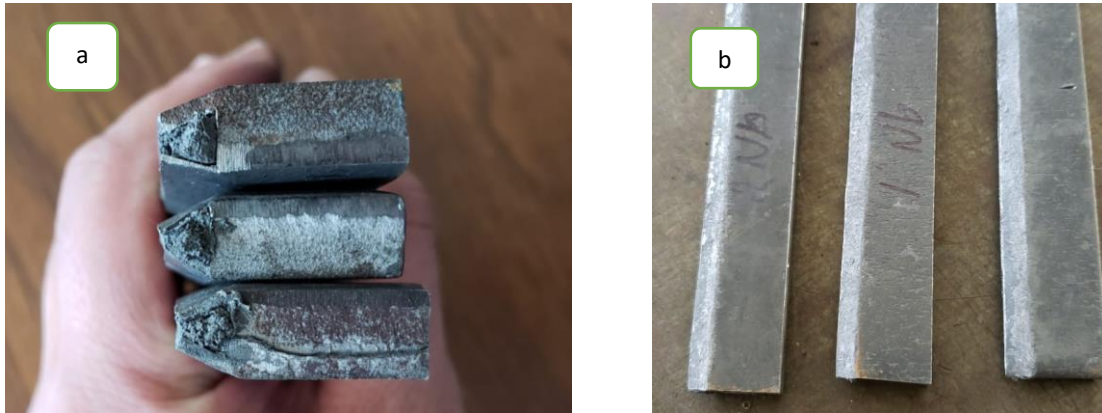
Figura 4.2 Unión de ranura del metal base a) vista frontal b) vista transversal
