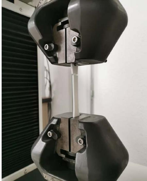
Figura 12 Muestra de PLA con relleno al 20 % ya fracturada en la prueba de tensión.
