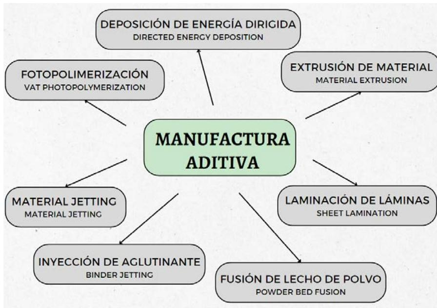
Figura 1 Clasificación de los métodos de manufactura aditiva según la ASTM (15).
