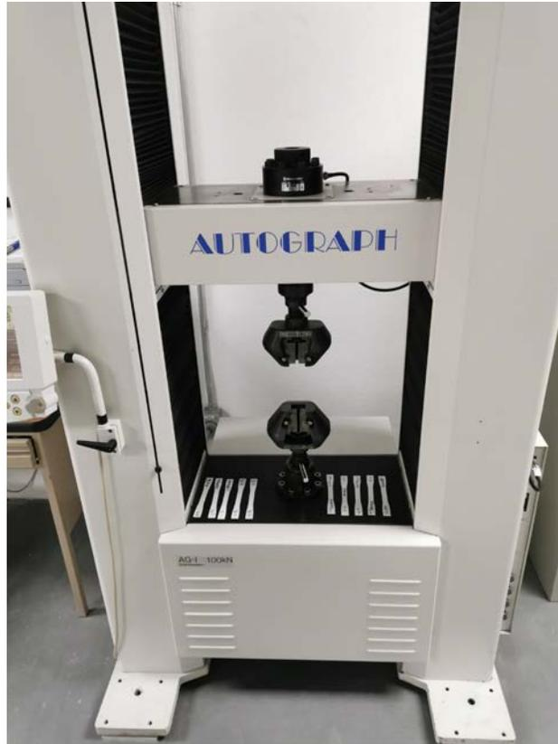
Figura 11 Máquina universal de pruebas Shimadzu AG-I.
