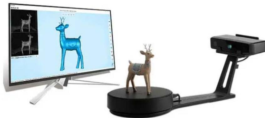
Figura 19 Un escáner 3D trabajando en una pequeña pieza (37).
