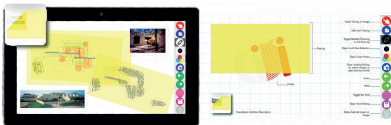
Imagen 2. Ventana de TraceSpace © mostrando sus elementos característicos. El área de trabajo puede extenderse a la izquierda o derecha, la barra de herramientas tiene todas las funciones principales y el papel de calco ( tracing ) es una superficie traslúcida que reproduce las características físicas del papel de calco.
