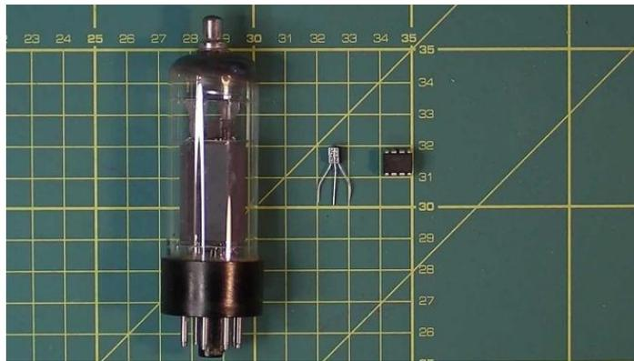
Imagen: Comparativa de izquierda a derecha del tamaño de las válvulas de vacío, el transistor y los circuitos integrados (Fuente: <https://www.youtube.com/watch?v=gQaDkdP9aPk>).
