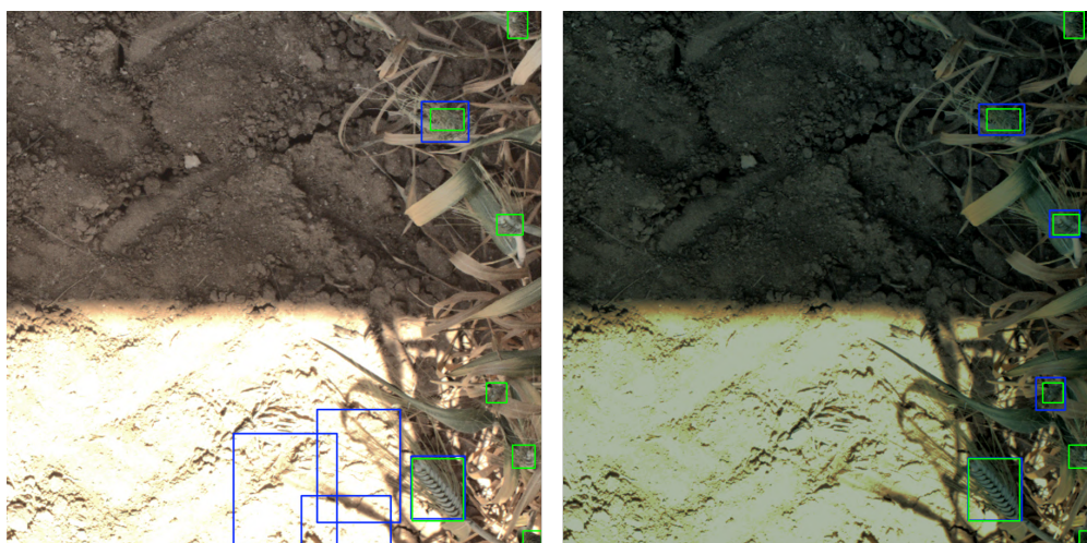
Figura 4.4 Comparación de espigas detectadas por el modelo base y por el mejor modelo obtenido, en una imagen con pocas espigas y una zona excesivamente iluminada. Las espigas reales se muestran en color verde y las detectadas en azul.
