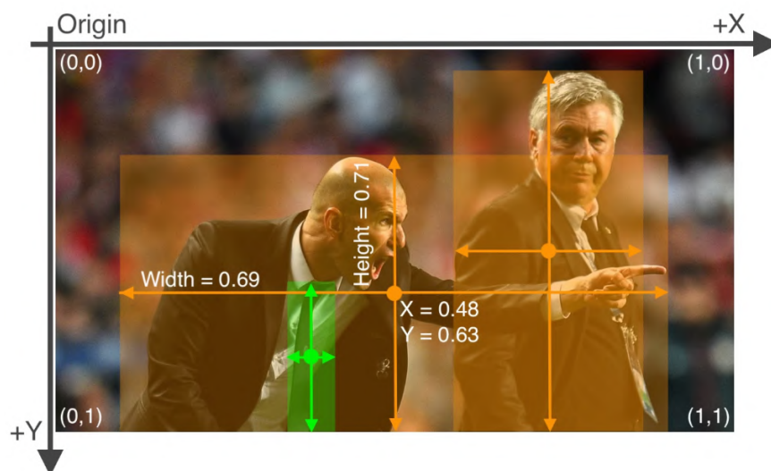
Figura 3.2 Ejemplo de etiquetas de un cuadro delimitador en el formato usado por los modelos YOLO [58].
