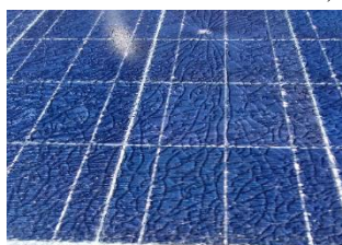
c) panel solar dañado por la granizada
