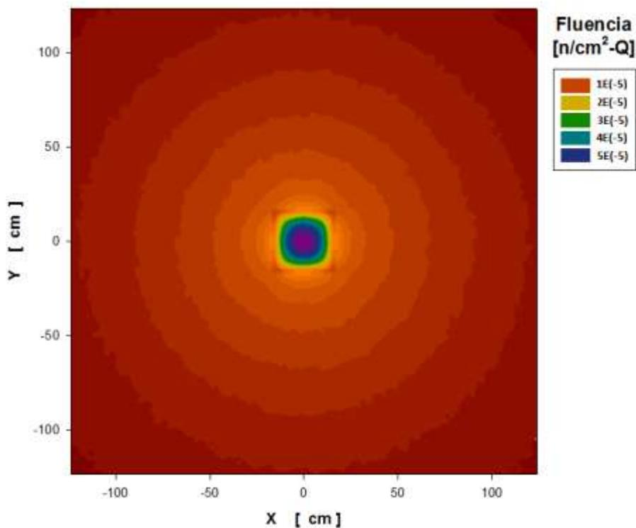
Figura 2.- Fluencia de neutrones en torno al IC.
