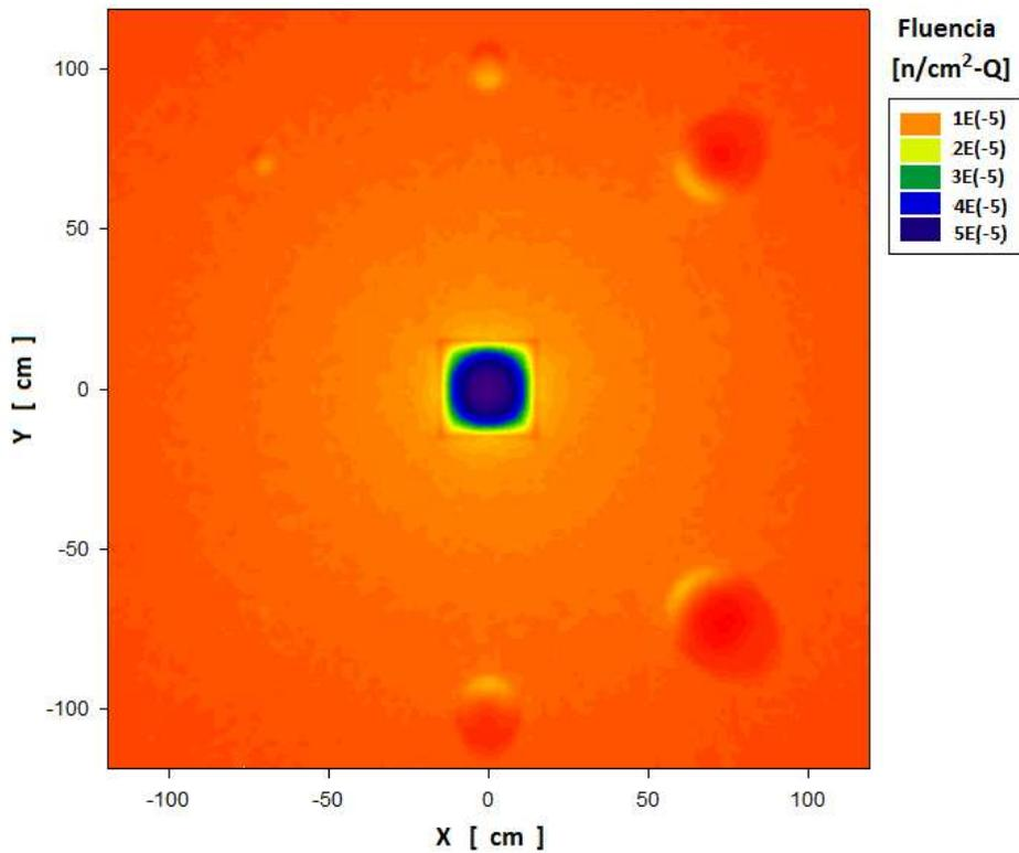
Figura 6.- Fluencia de neutrones en la sala con las esferas cada 45°
