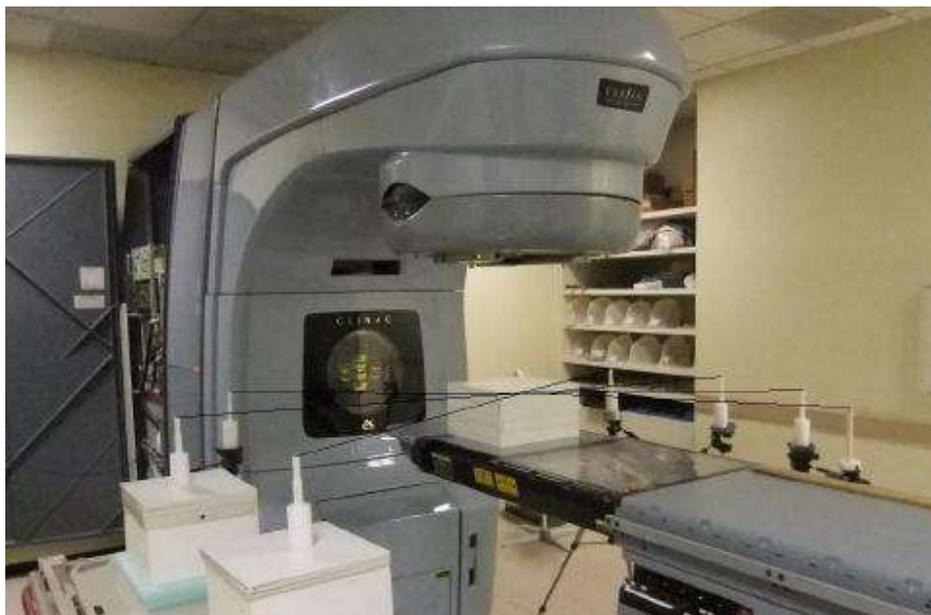
Figura 1.- Bases de las esferas Bonner ubicadas en modo Planetario.
